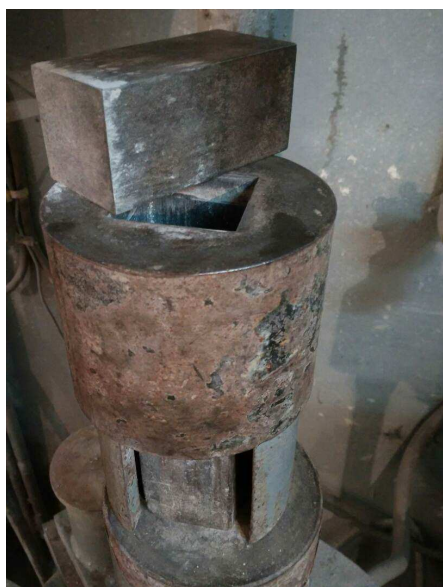
Рис. 5. Прес-форма для формування зразків
