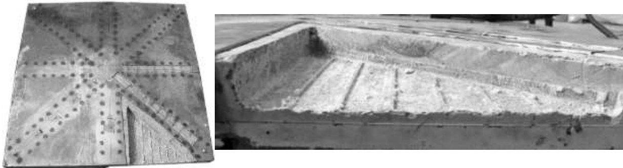
Рис. 7. Розкрита після випробувань пустота зразка СПБ50.
