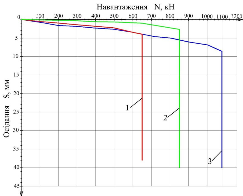
Рис. 1 Графіки залежності осідань паль від вертикальних навантажень: 1 – неармована ґрунтоцементна палі; 2 – ВАГЦП №1; 3 – ВАГЦП №2
