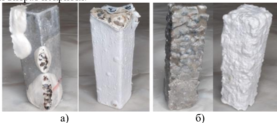
Рис. 2. Зразки з антикорозійними покриттями після випробувань: а – зразки покриті загальноприйнятою технологією; б – зразки, що були попередньо підготовлені, з полімербетонним поверхневим шаром
