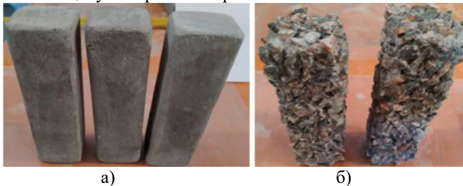
Рис.1. Зразки перед нанесенням захисних покриттів:
