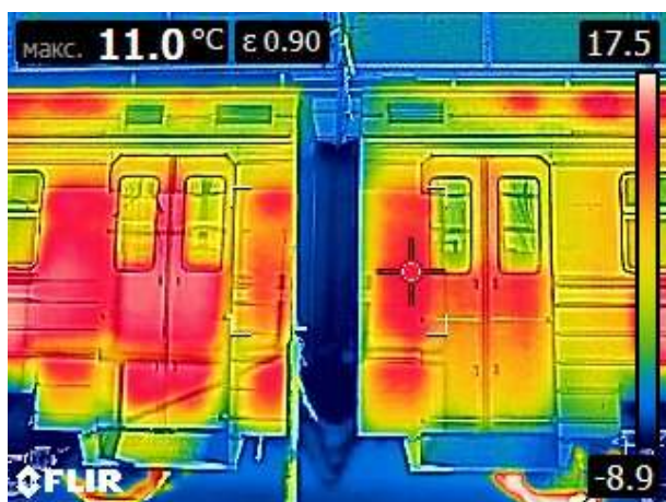
Рис. 1 Термограма дверей електропоїзда
