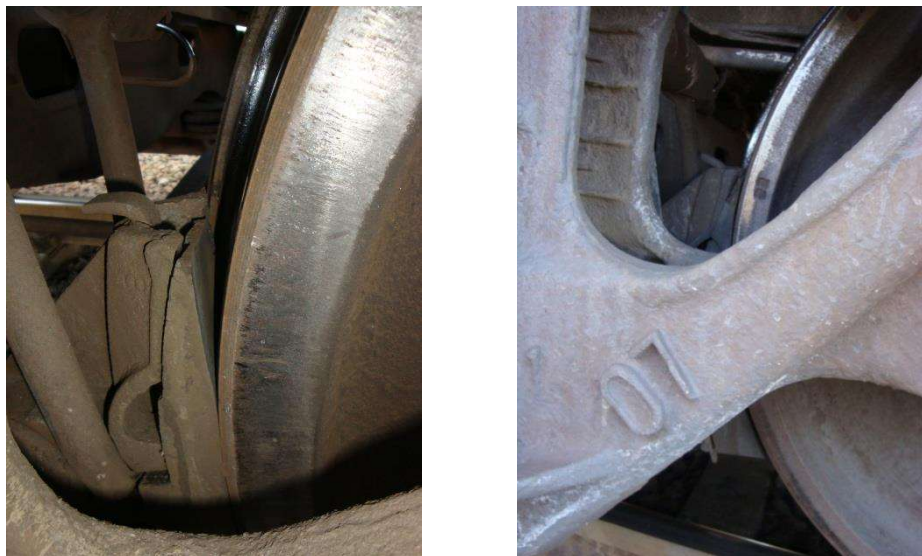
Рис. 1. Клиноподібно зношені гальмівні колодки вагонів
