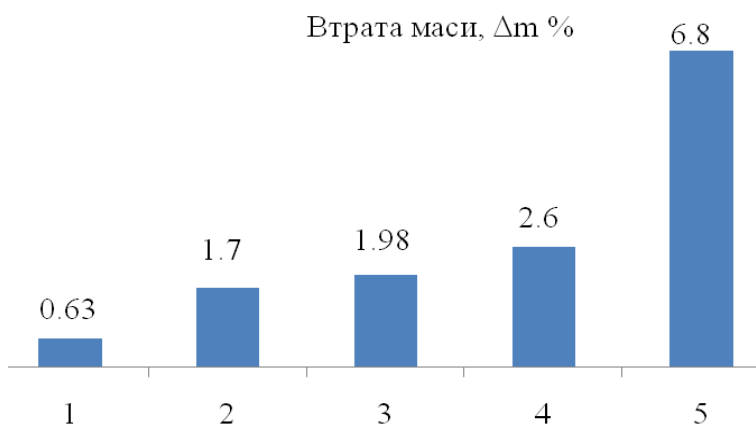
Рис. 2. Результати втрати маси зразків \Delta m , % вогнезахисної деревини покриттям на органічній основі з додаванням: 1 – алюмосилікатних мікросфер; 2 – перліту; 3 – базальтової луски; 4 – золи; 5 – металургійного шламу
