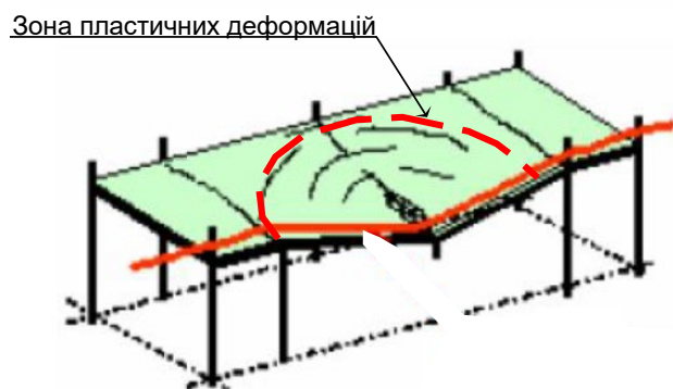
Рис. 1. Лінія утворених пластичних деформацій що розглядаються як рухомі механічні в'язі (пластичні шарніри)
