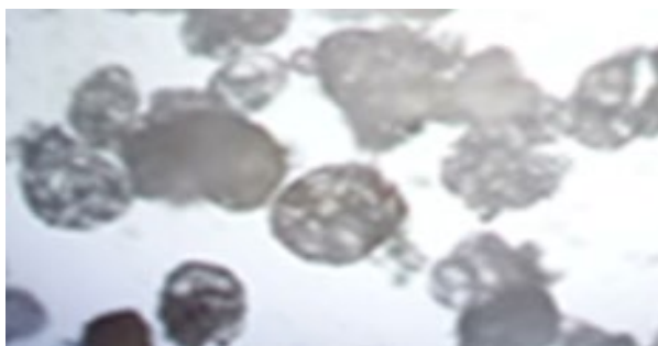
Рис. 3. Алюмосиликатные микросферы с множеством внутренних перегородок при увеличении 144х
