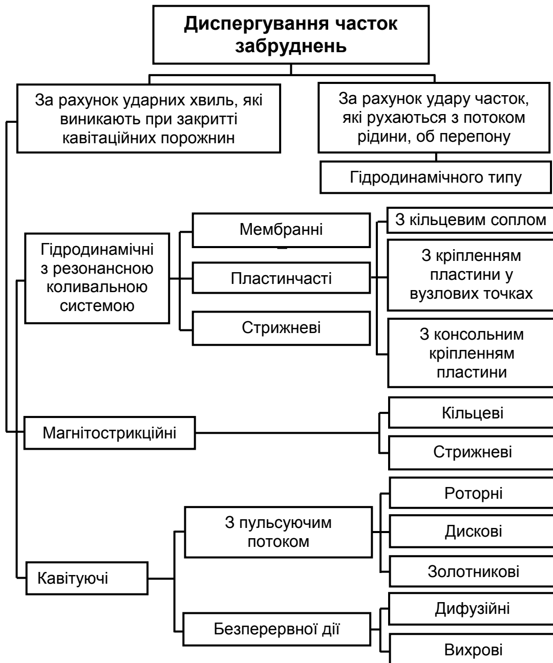
Рисунок 8 – Класифікація методів диспергування і диспергуючих пристроїв
