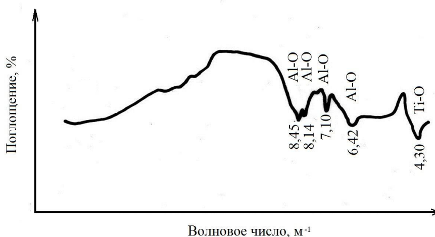
Рис. 5.3 – ИК–спектр пробы 50 % \text{BaAl}_2\text{O}_4 + 50 % \text{BaTiO}_3 , полученной обжигом при температуре 1500 °С
