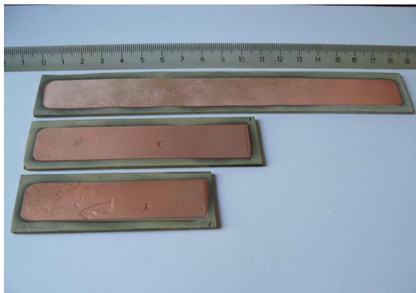
Рис. 6.58 – Детали волновода после обжига и нанесения медных электродов
