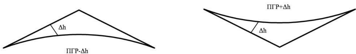
Рисунок 2.2 – Розміщення вертикальної кривої
