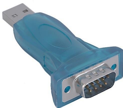
Рисунок Б.5 – Адаптер USB → RS-232
