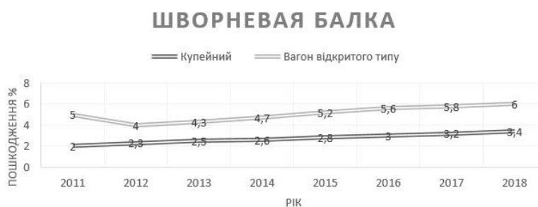
Рис. 3. Аналіз зносу шворневої балки пасажирських вагонів
