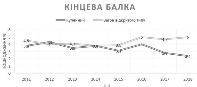
Рис. 4. Аналіз зносу кінцевої балки пасажирських вагонів
