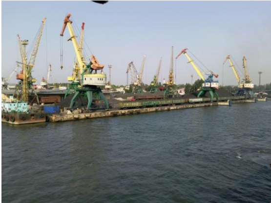
Рисунок 2.9 – Технологія грейферного розвантаження напіввагонів в умовах морського порту: розвантажувальний майданчик (а); взаємодія грейфера з напіввагоном (б)
