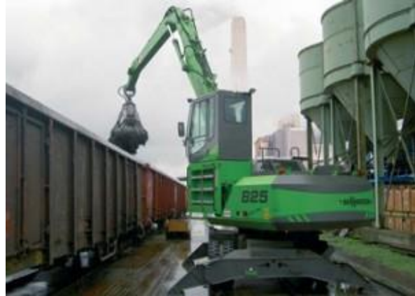
Рисунок 2.9 – Технологія грейферного розвантаження напіввагонів в умовах морського порту: розвантажувальний майданчик (а); взаємодія грейфера з напіввагоном (б)
