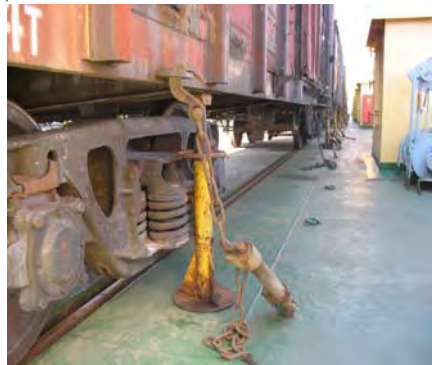
Рисунок 1. - Випадковість місць закріплення ланцюгових стяжок за елементи конструкції вагонів.
