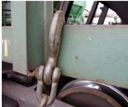
Рисунок 1. - Випадковість місць закріплення ланцюгових стяжок за елементи конструкції вагонів.
