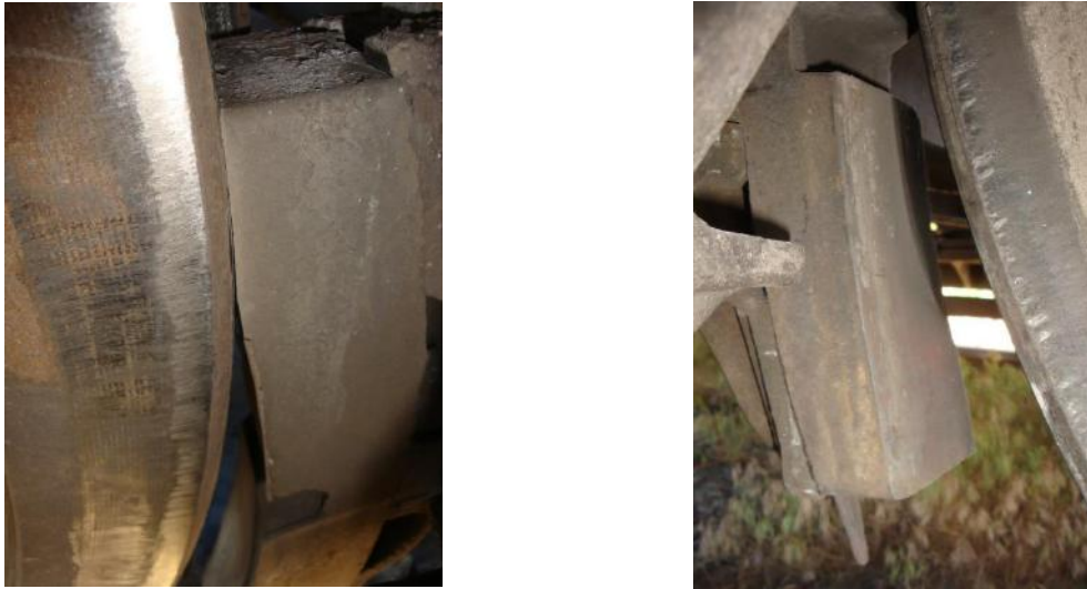
Рис. 5. Зображення клинодуального зносу гальмової колодки в експлуатації
