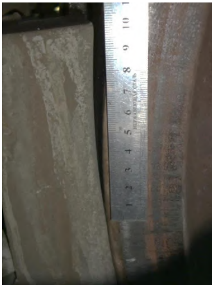
Рис. 3. Вимірювання довжини шкідливого зносу гальмової колодки, що утворився в експлуатації
