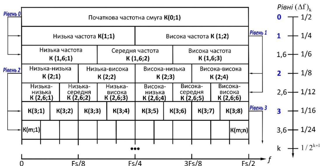
Рис. 1. Частотно-смуговий розподіл із застосуванням 1/3-бінарного дерева фільтрів
