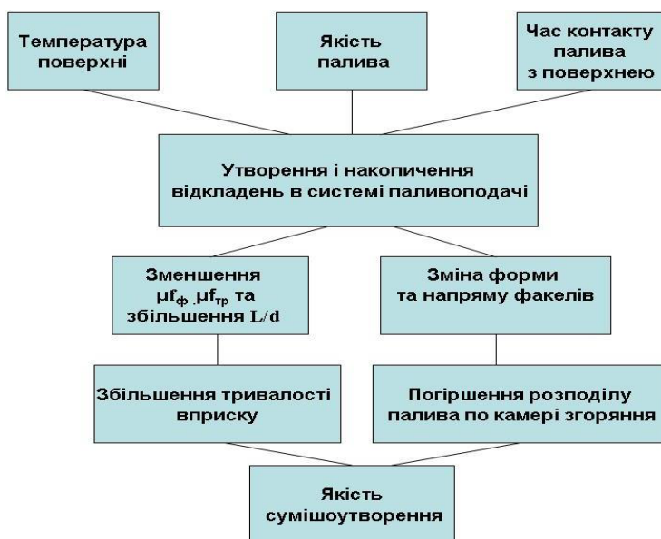
Рис. 4 – Фактори, що впливають на утворення вуглецевих відкладень на елементах системи паливоподачі тепловозних дизелів та їх вплив на якість сумішоутворення у циліндрах двигуна
