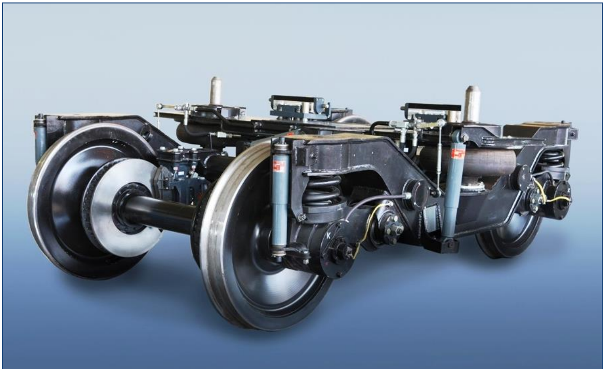
Рис. 11.6. Візок моделі 68-7047 для вагона міжнародного сполучення габариту RIC моделі 61-7034
