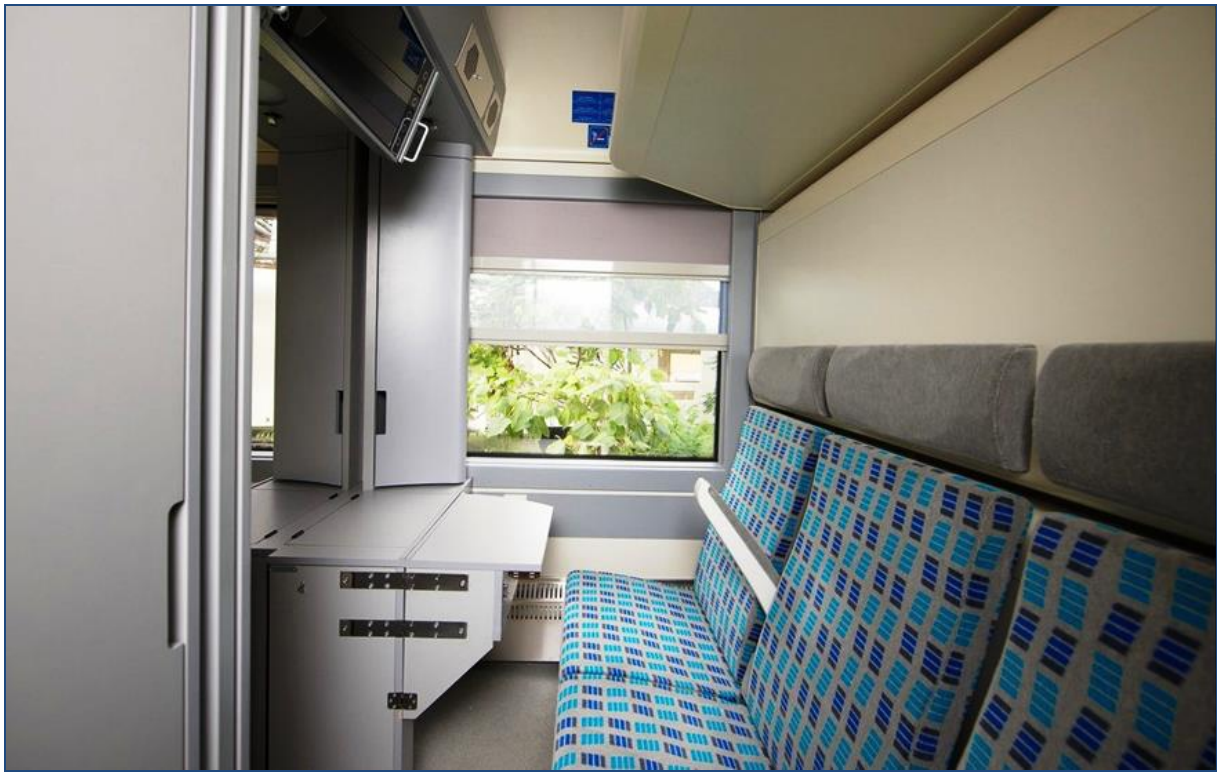
Рис. 12.1. Пасажирське купе з місцями для сидіння у вагоні міжнародного сполучення габариту РІЦ
