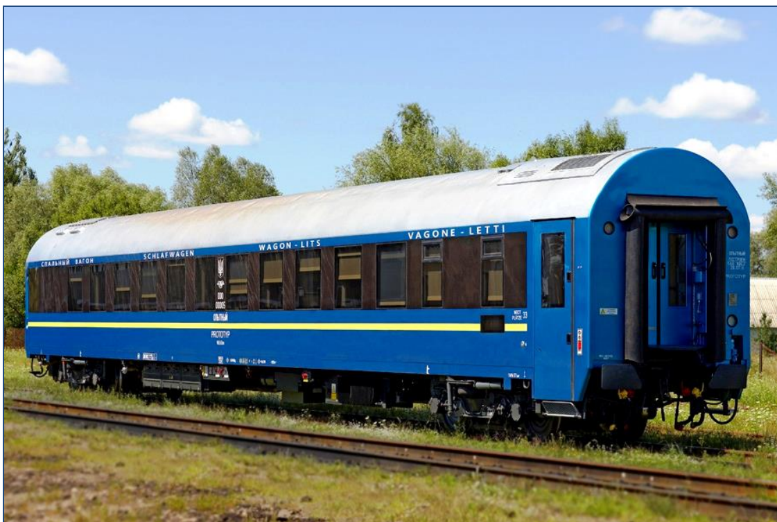
Рис. 11.3. Вагон суцільнометалевий для міжнародного сполучення габариту РІЦ моделі 61-7034 Крюківського вагонобудівного заводу
