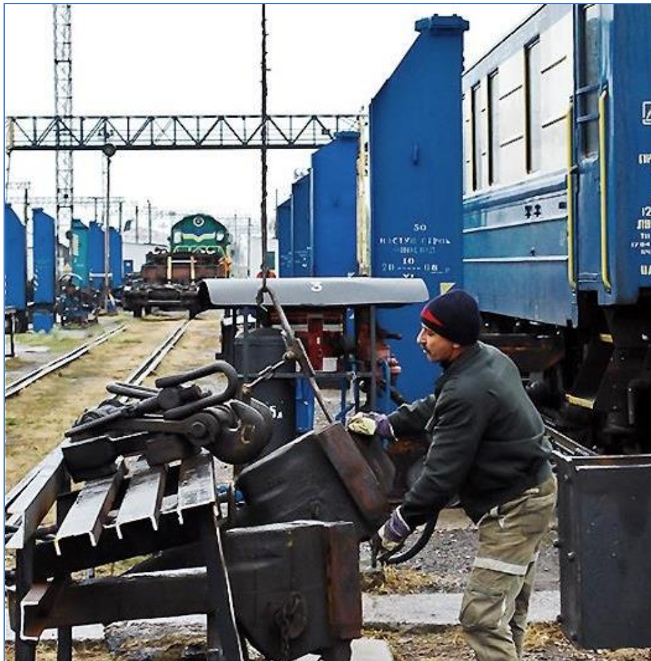
Рис. 10.2. Заміна вагонних зчіпок пасажирського поїзда у пункті перестановки вагонів
