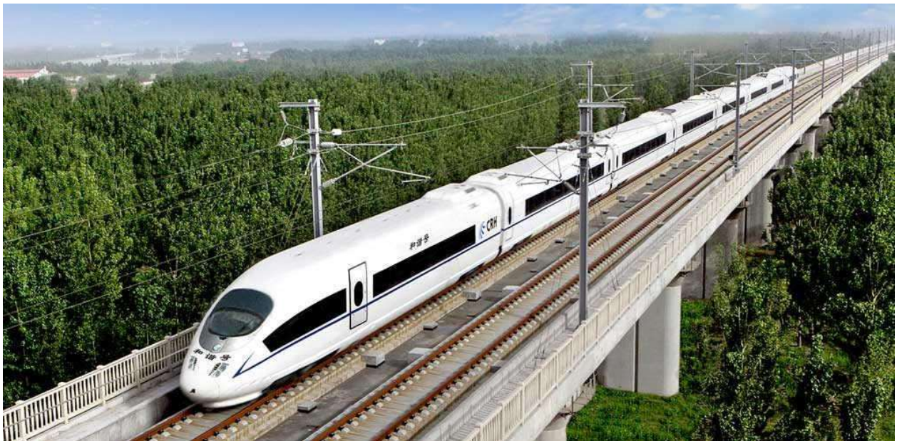
Рис.3 - Безбаласний шлях на ділянці високошвидкісної лінії КНР
