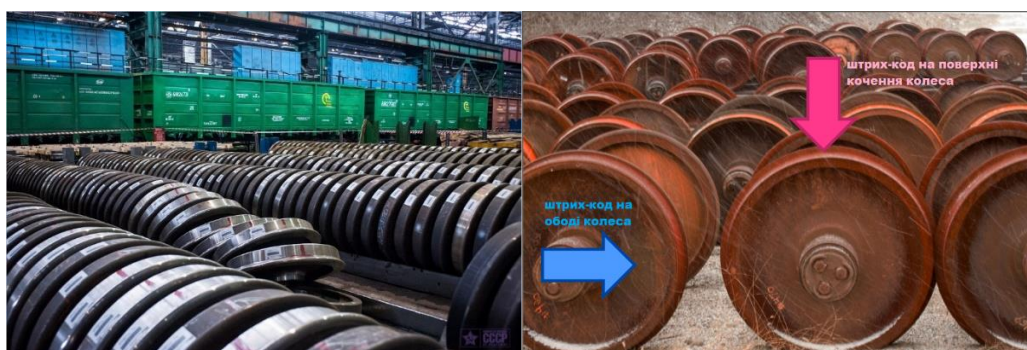
Рис. 2. Варіанти розташування штрих-коду на елементах колісної пари
