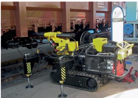
Рис. 1. Мобільна установка правки та заміни люків напіввагонів
