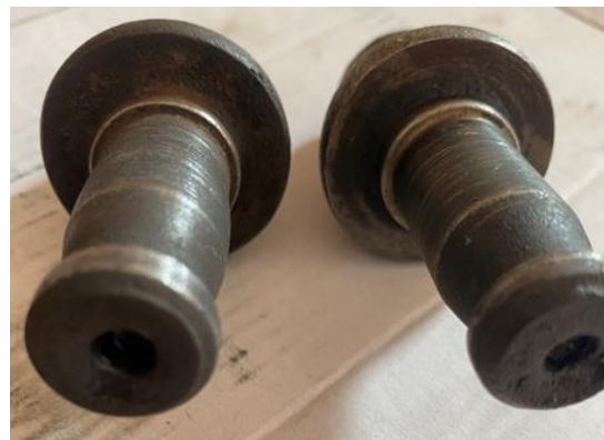
Рис. 2. Різці після відновлення роздаванням корпусу різця
