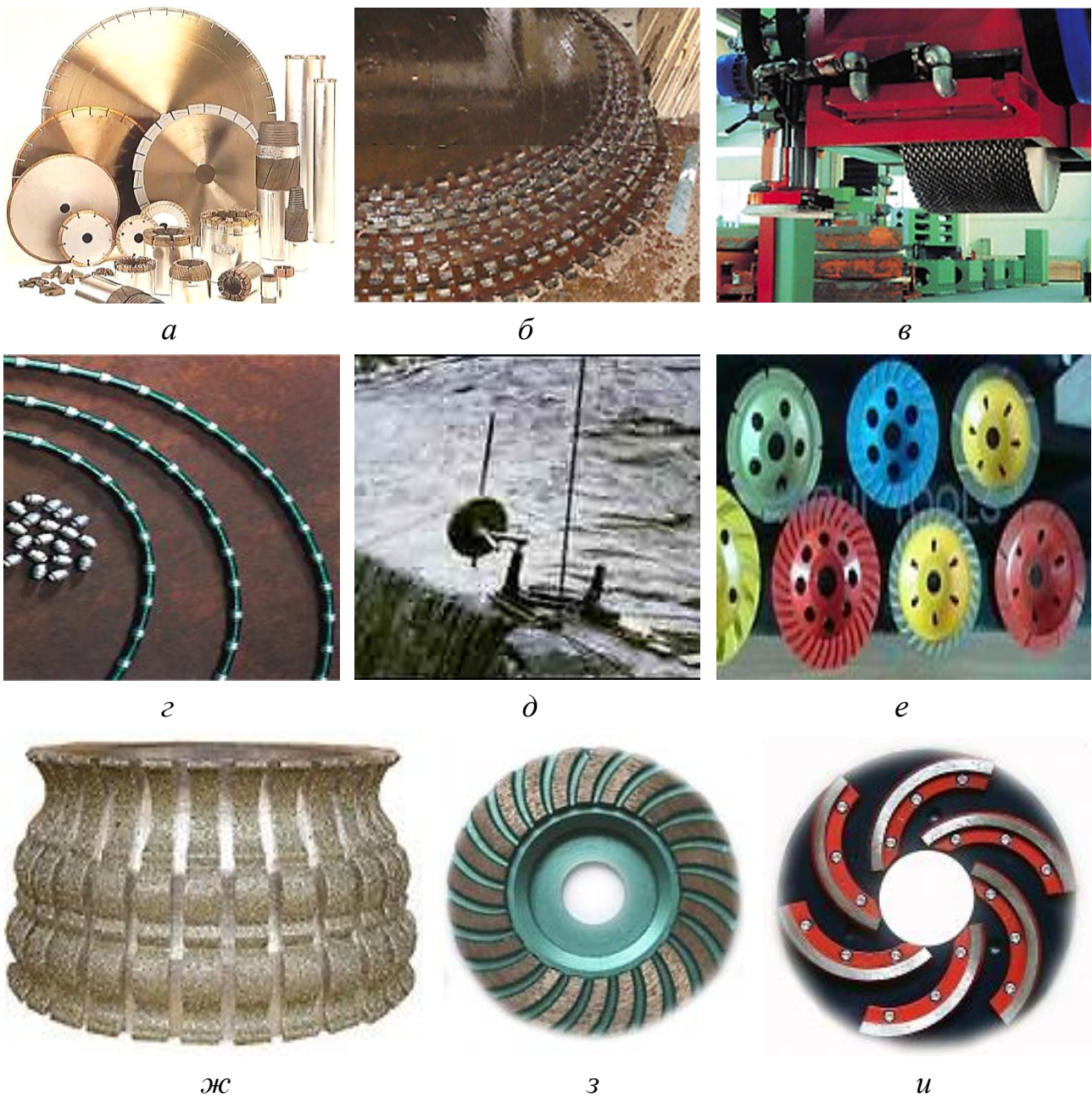
Рисунок 1.1 – Відрізні круги (а–в), канатні пили (г, д) та шліфувальні інструменти (е–и), що виготовлені з композитів системи алмаз–Fe–Cu–Ni–Sn
