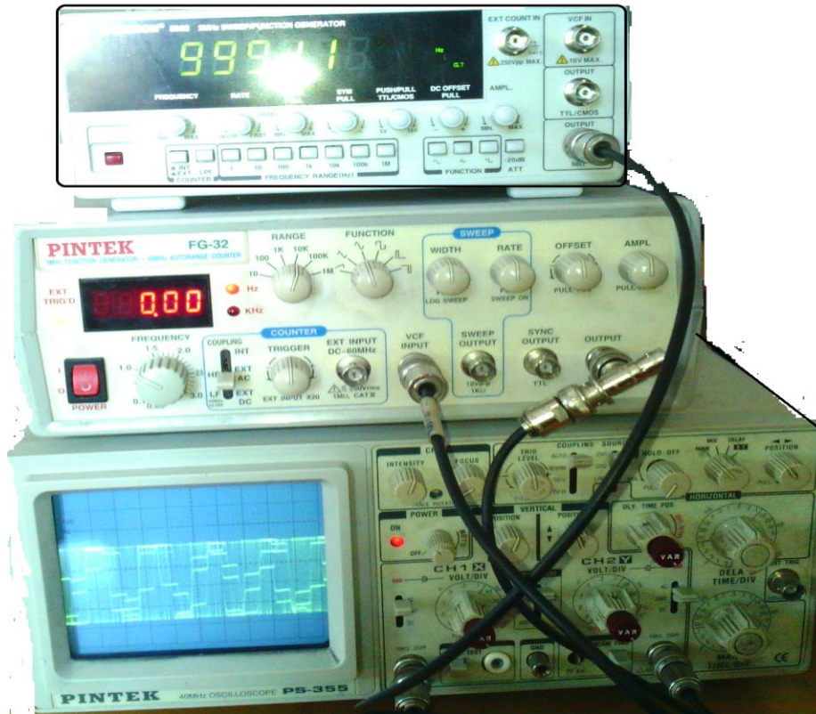
Рисунок 12 – Схема підключення генератора функцій FG-32 при формуванні модульованого сигналу
