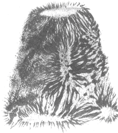
Рисунок 4 - Розташування частинок феромагнітного матеріалу на пристрої, що відображає, із захистом від перешкод
