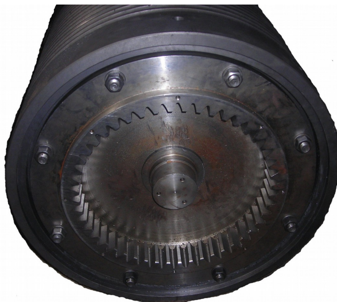
Рис. 2.17. Лобовина канатного барабана, який має вбудовану зубчасту муфту
