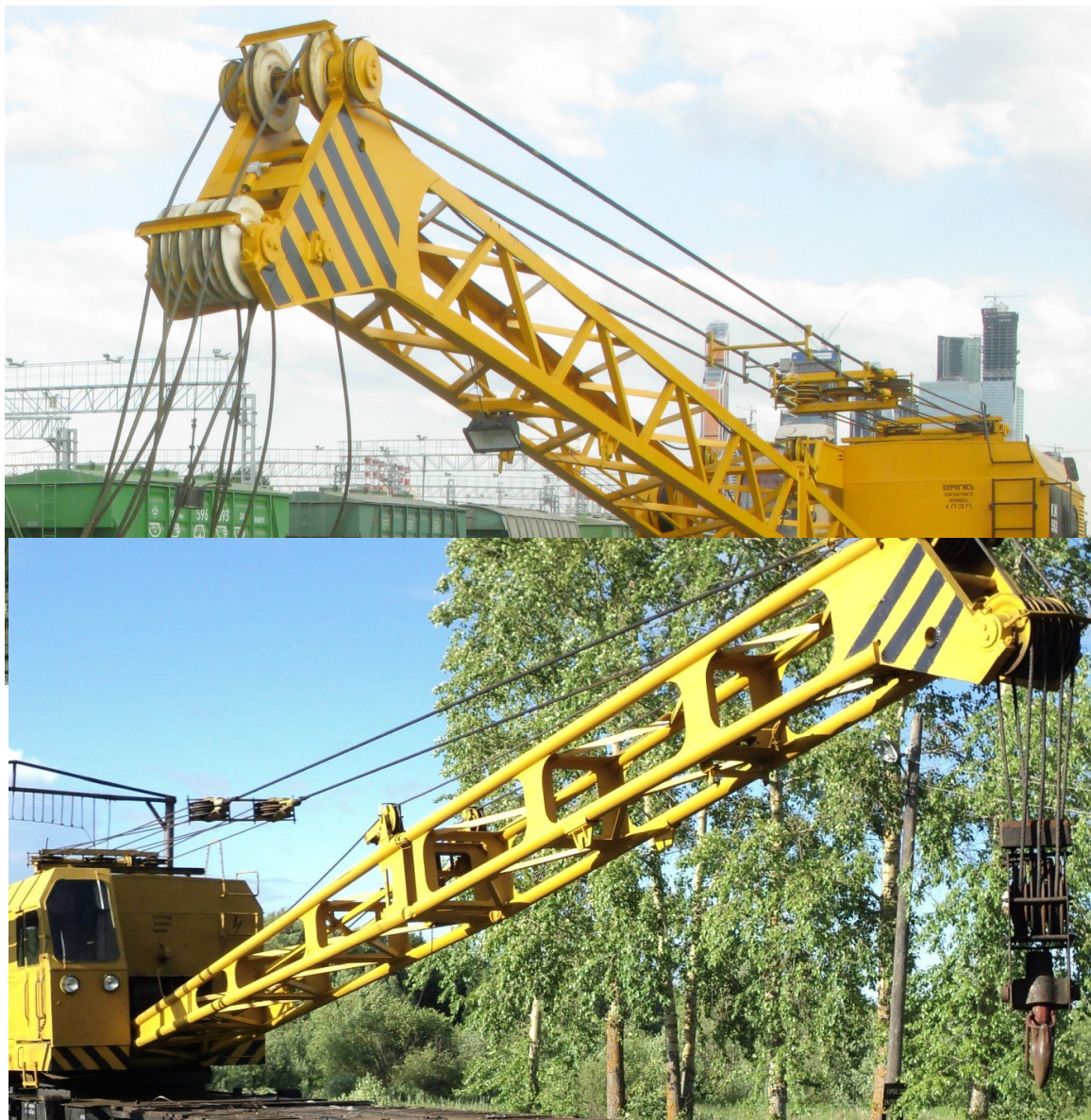
Рис. 4.25. Стріла крана КЖДЭ-16 трубчастої конструкції
