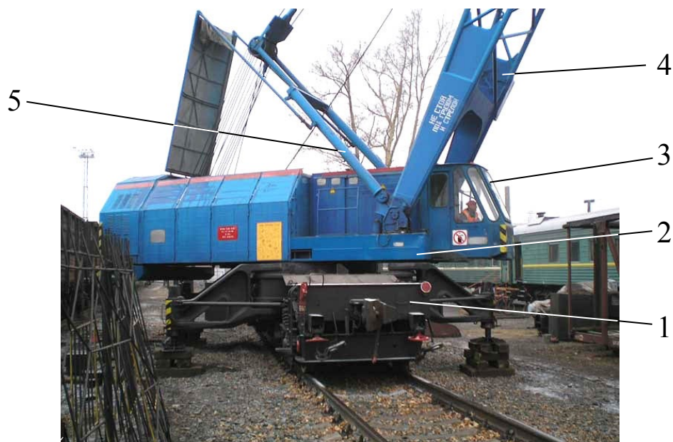
Рис. 2.1. Кран ЕДК-300/200 під час роботи: 1 – ходова частина; 2 – поворотна частина; 3 – кабіна керування; 4 – стріла; 5 – портал
