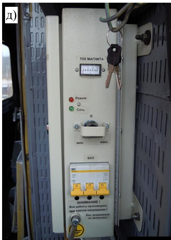
Рис. 4.20. Кабіна крана КЖ-561: а – вигляд кабіни; б – пульт керування; в – педалі керування; г – обмежувач навантаження крана; д – блок керування вантажопідйомним електромагнітом
