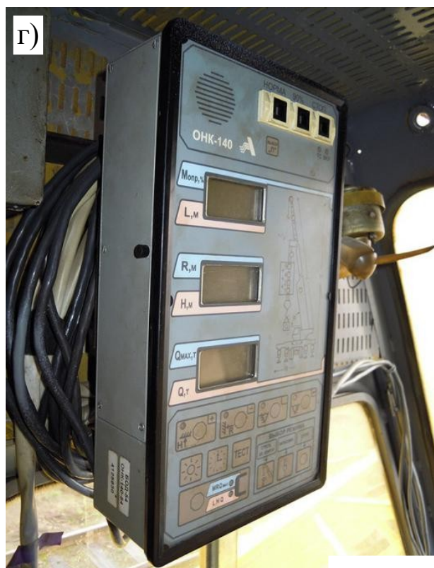
Рис. 4.20. Кабіна крана КЖ-561: а – вигляд кабіни; б – пульт керування; в – педалі керування; г – обмежувач навантаження крана; д – блок керування вантажопідйомним електромагнітом
