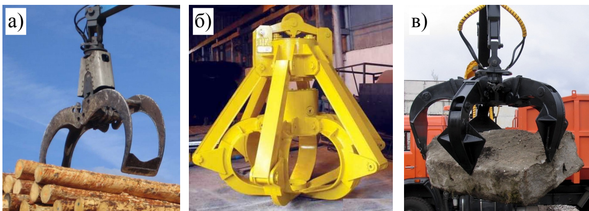
Рис. 2.13. Грейферні захоплювачі: а – кліщовий для круглого лісу; б – багатощелепний для металобрухту; в – багатощелепний універсальний
