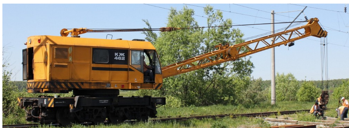
Рис. 4.12. Кран КЖ-462 на монтажних роботах
