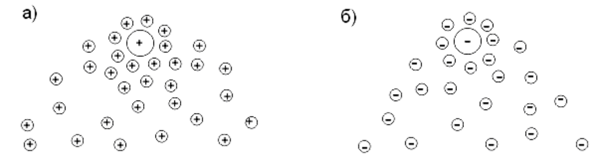
Рис. 2.6. Уніполярний режим корони при позитивній (а) та негативній (б) напругах
