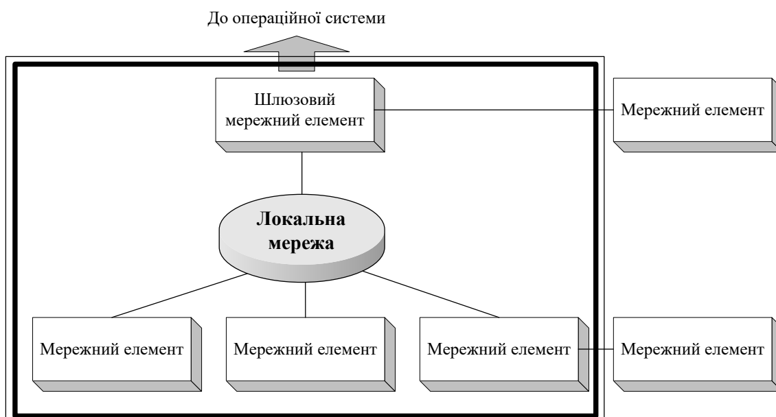
Рис. 9.9. Схема організації керуючих зв'язків через локальну мережу (товста лінія – тракт SDH; тонка – влаштований канал передавання даних)
