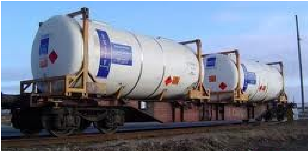
Рис. 9.14. Навантаження контейнерів-цистерн з небезпечними рідкими вантажами на залізничну платформу
