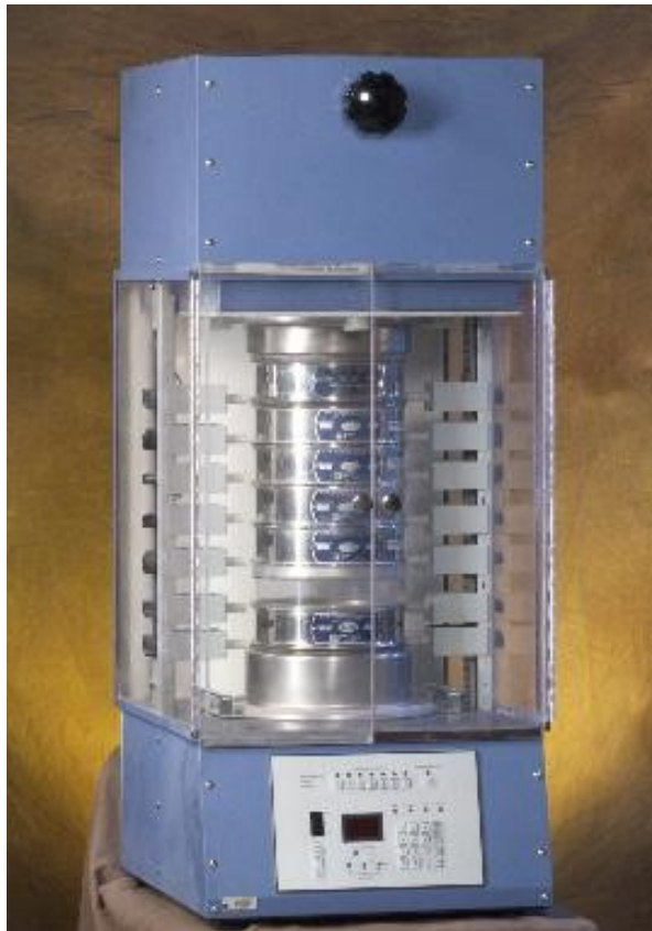
Рис. 2.1. Прилад, що використовується для просіювання і фракціонування металургійних порошків. Фото: NASA-GRC
