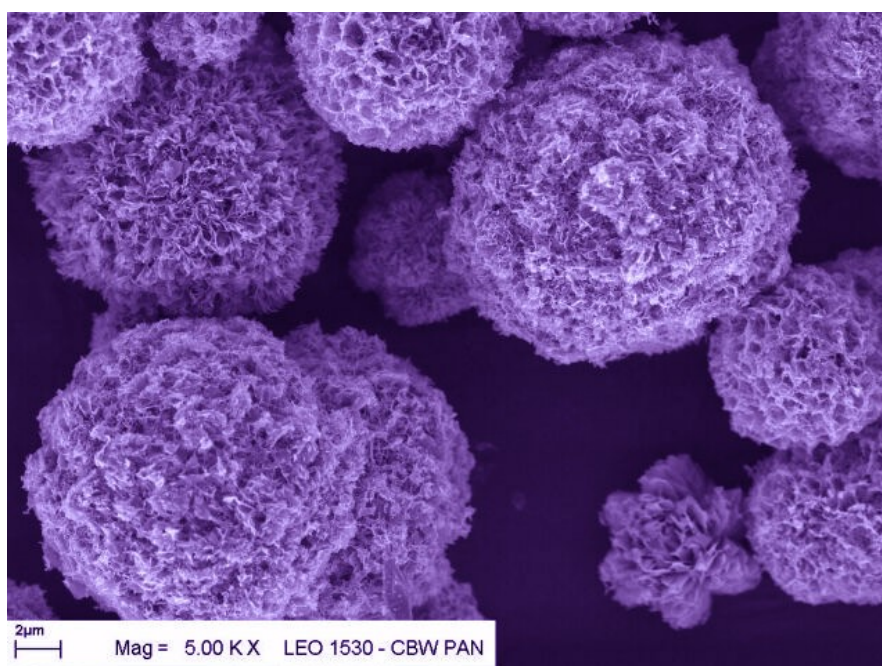
Рис. 2.2. Нанопорошок оксиду цинку, отриманий гідротермально-мікрохвильовим синтезом
