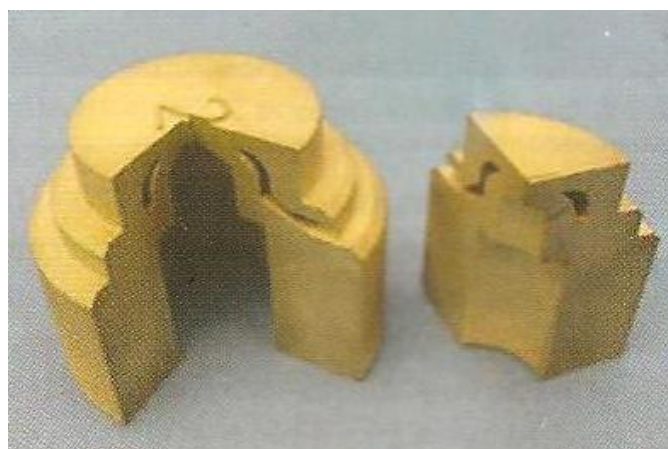
Рис. 2.103. Деталь, виготовлена з металу за технологією ProMetal
