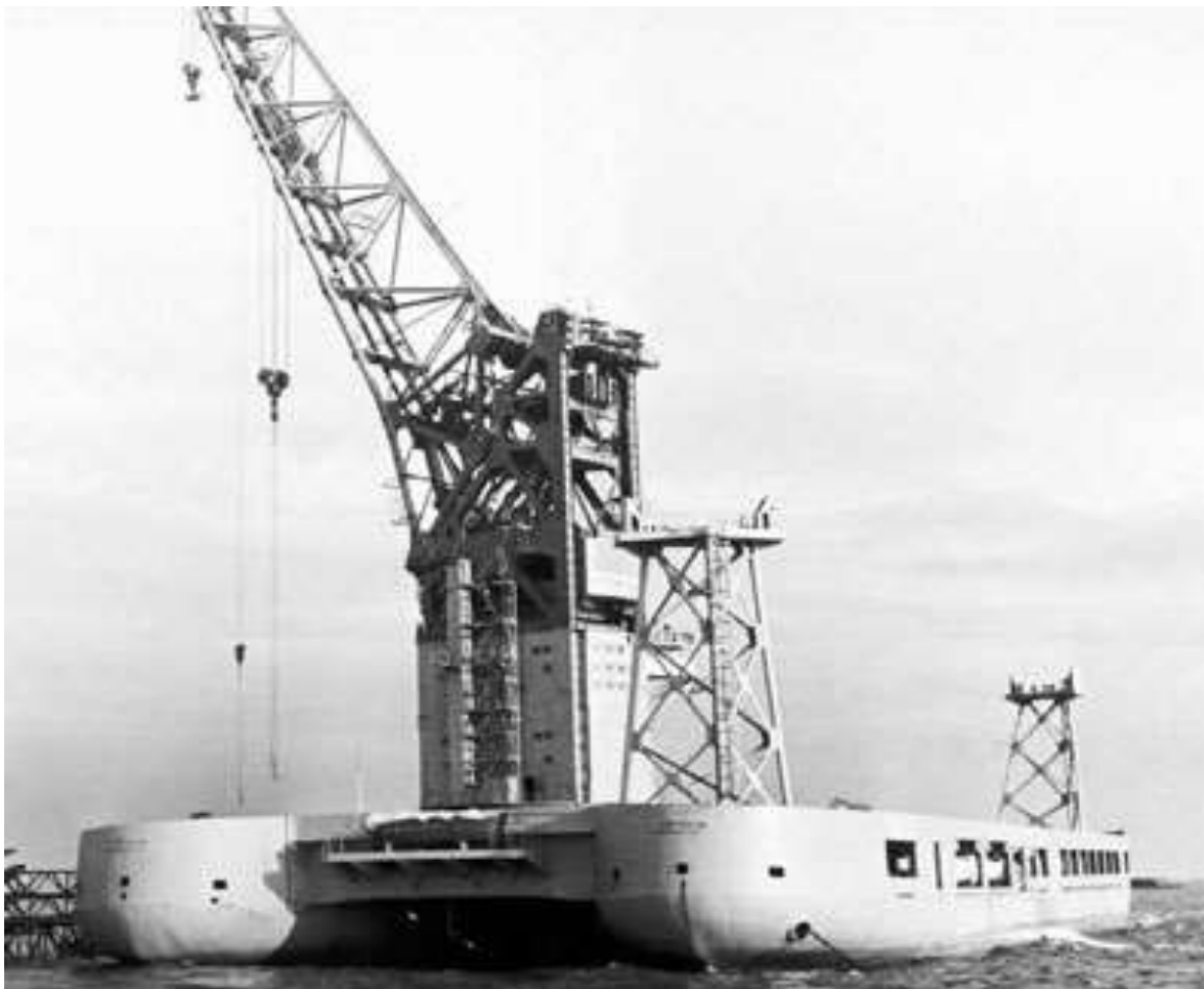
Рис. 3.28. Двотілове морське самохідне транспортно-монтажне судно «Кер-Оглы» вантажопідйомністю 250 т
