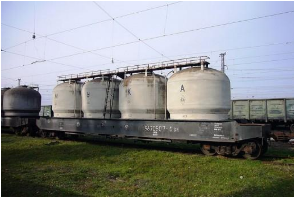
Рис. 12.7. Бункерний напіввагон для перевезення муки
