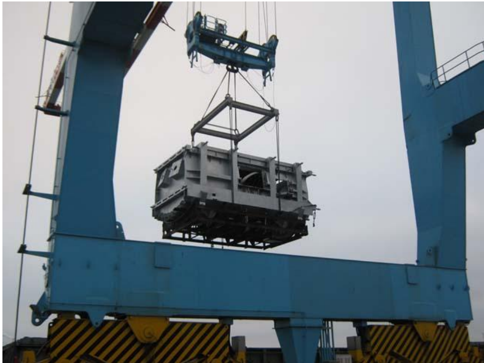
Рис. 3.27. Перевантаження великовагових вантажів на ТСК із застосуванням спеціальних траверс
