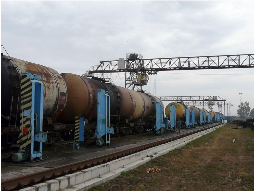
Рис. 1.17. Технологія залізничних перевезень з заміною колісних пар за допомогою гвинтових домкратів
