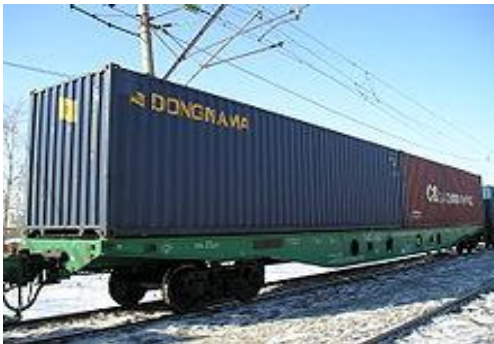
Рис. 12.11. Подовжена фітингова платформа з двома 40-футовими контейнерами
