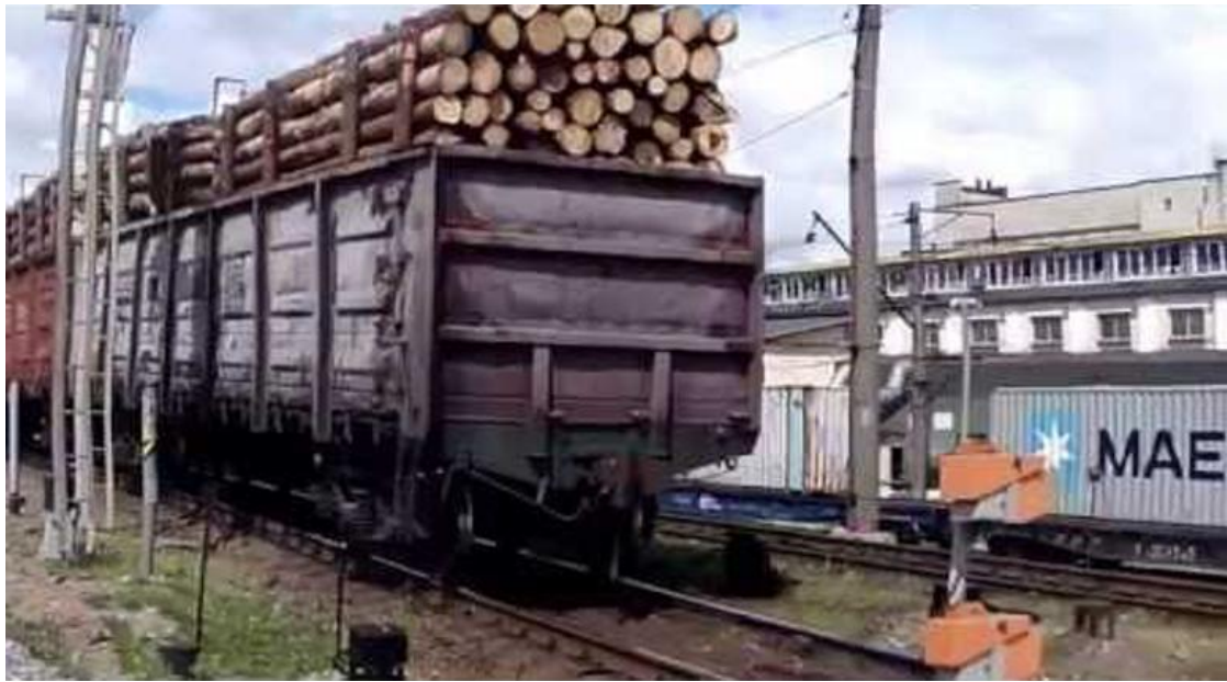
Рис. 12.19. Навантаження круглого лісоматеріалу в напіввагон з використанням зонального габариту
