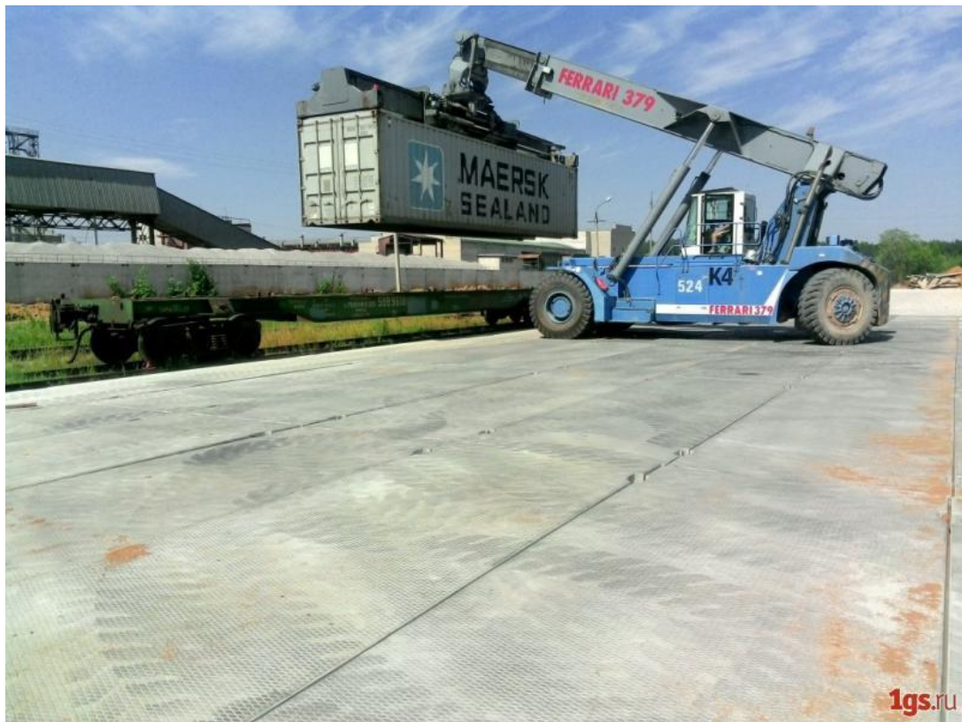
Рис. 3.20. Навантаження 40-футового контейнера навантажувачем на залізничну платформу на контейнерному терміналі ТСК
