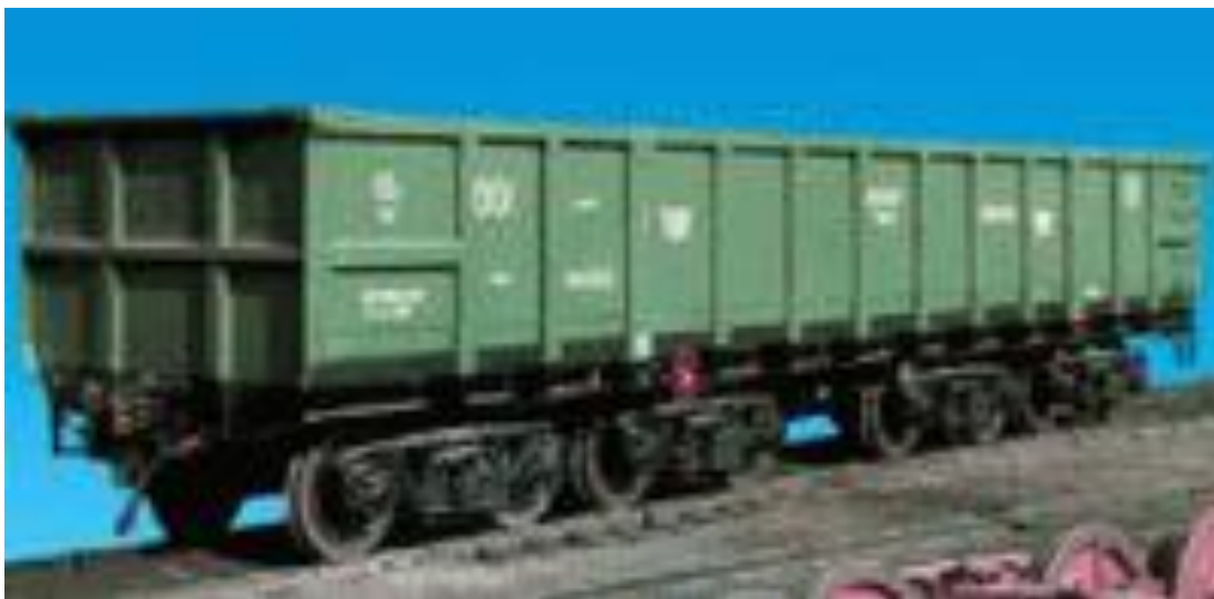
Рис. 12.17. Восьмивісний напіввагон з глухою підлогою для рудно-металургійної сировини
