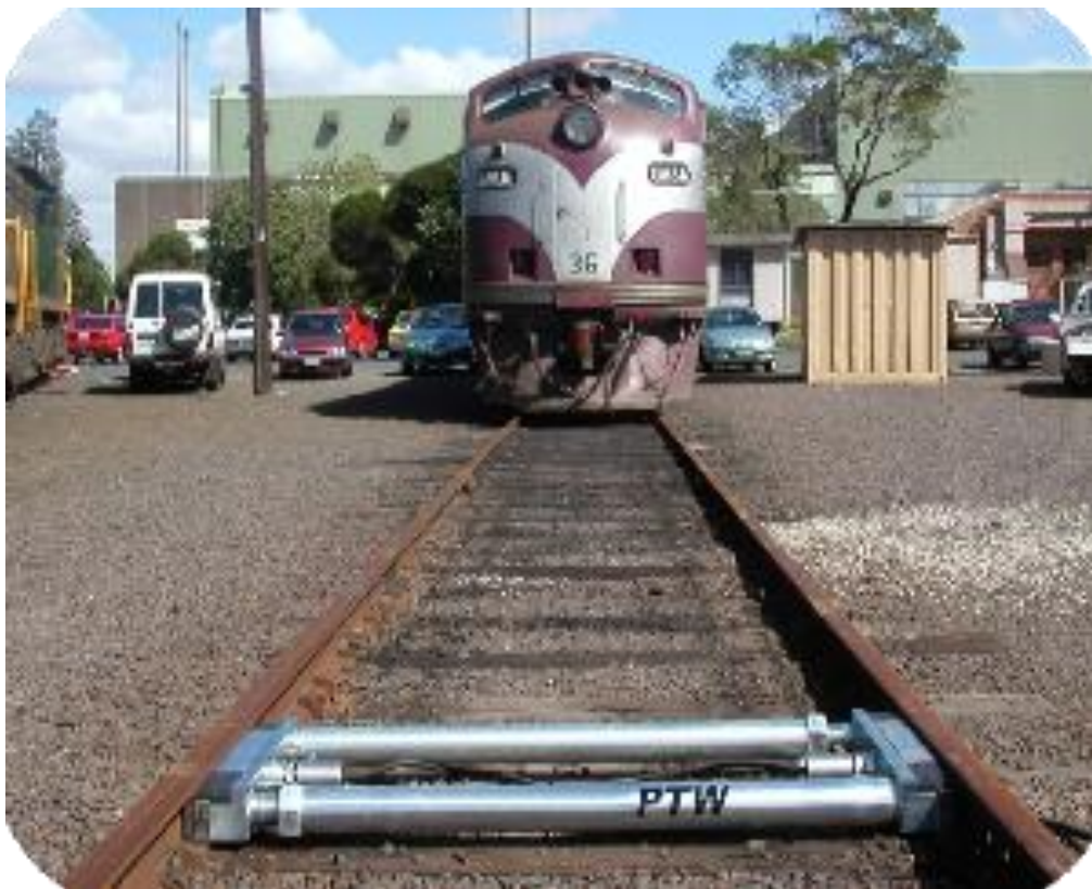
Рис. 6.10. Підготовлені до зважування вагонні ваги. Час на встановлення і монтаж 15 хв
