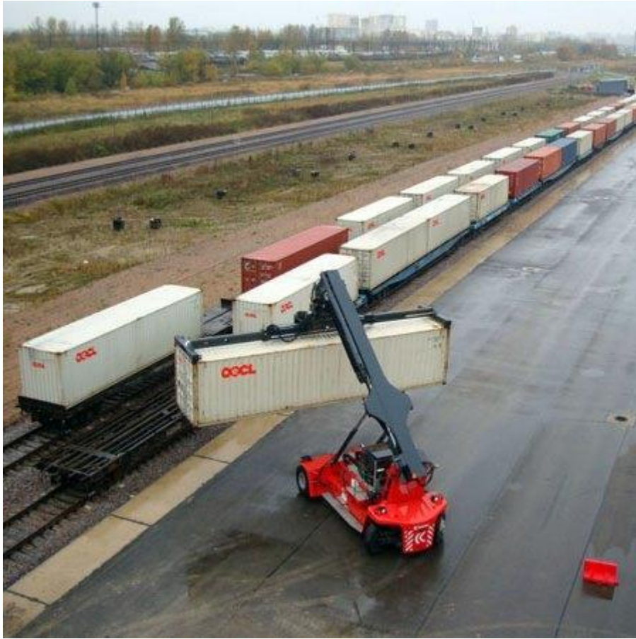
Рис. 1.18. Технологія перевантаження 40-футових великотоннажних контейнерів із вагонів широкої у вагони вузької колії за допомогою пневмоколісного перевантажувача
