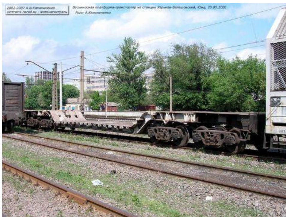
Рис.12.8. Восьмивісний вагон-транспортер для негабаритних і великовагових вантажів
