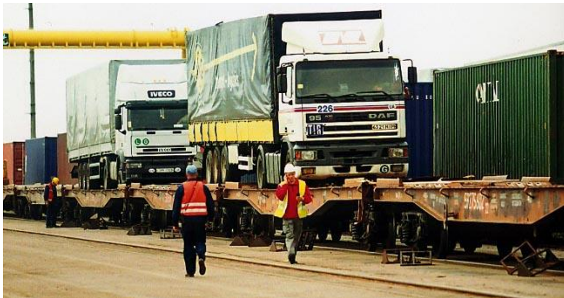
Рис. 1.14. Перевезення автомобільних вантажних модулів на залізничних платформах (контрейлерна технологія вантажних перевезень)
