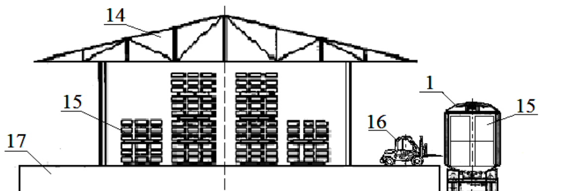
Рис. 3.59. Подача транспортного засобу під склад вантажоодержувача
