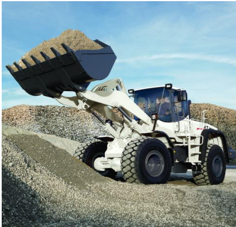
Рис. 6.15. Ваги на фронтальному навантажувачі для зважування навалочних вантажів у процесі видачі їх з ТСК (вантажного району) УДЦТС «Ліски»
