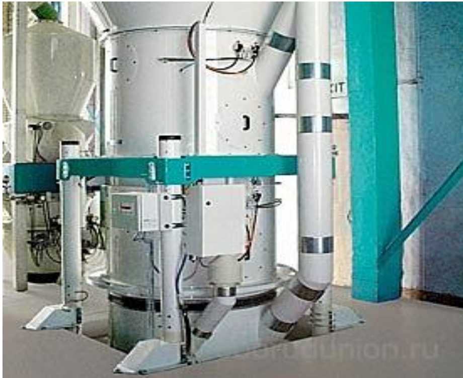
Рис. 6.17. Ваги ківшеві елеваторні (загальний вигляд) GranexMSDT
