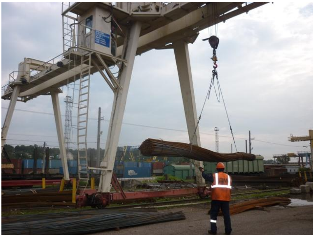
Рис. 3.26. Переробка металовиробів у пакетах електрокозловим краном КДКК-10 вантажністю 10 т на ТСК
