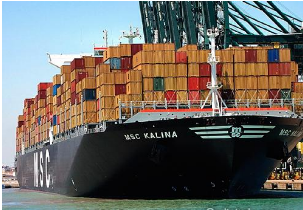
Рис. 1.9. Навантаження контейнерів на контейнеровоз MSC KALINA (параметри судна: габарит: довжина – 382 м, ширина – 54,2 м, осадка – 13,5 м; кількість грібних гвинтів – два; кількість головних двигунів – два, потужністю по 45000 кВт кожний; вантажопідйомність: трюми – 6230 TEU, палуба – 7210 TEU; проектна швидкість – 25,5 вузлів)
