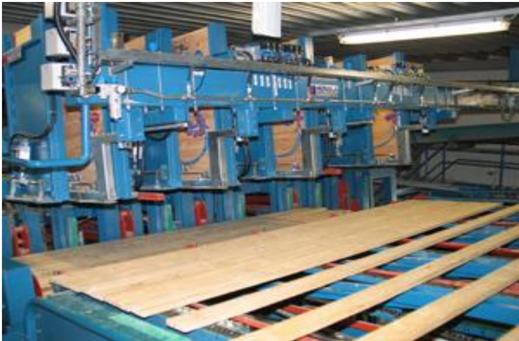
Рис. 11.9. Пакетувальна машина для пиломатеріалів моделі HEINOLA
