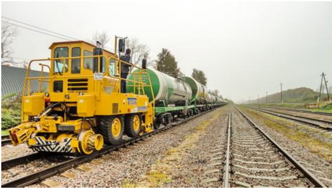
Рис. 20.1. Подача маршруту цистерн під налив тракторбайлом (тепловозом) МППЗТ на під'їзній колії промислової станції нафтопереробного заводу
