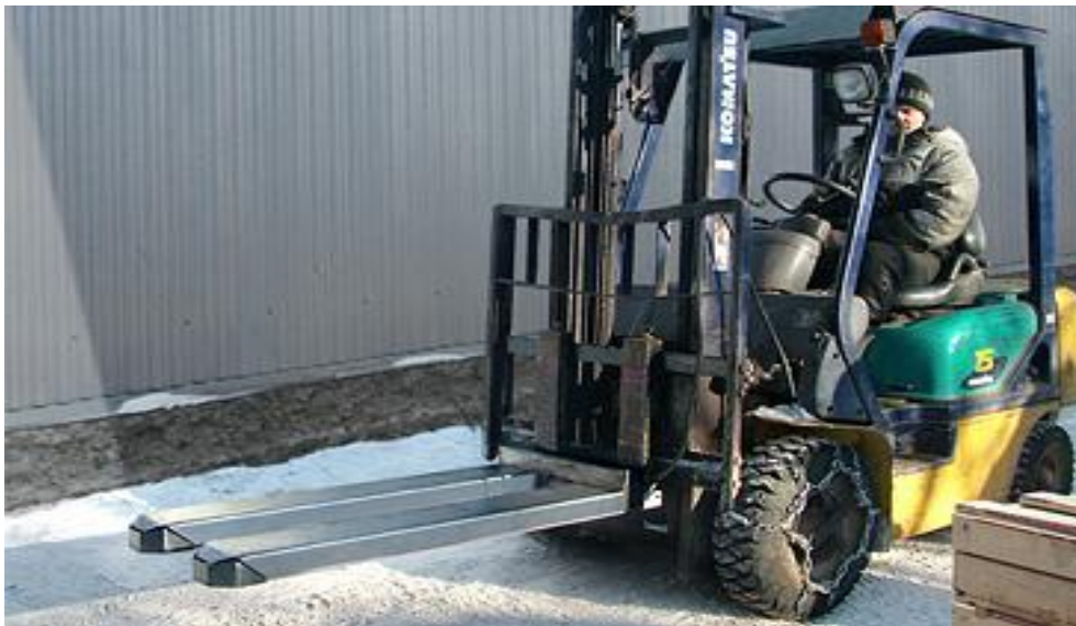
Рис. 6.14. Ваги для зважування вантажу під час вантажних операцій автонавантажувачем, балочні, накладені на вила навантажувача, моделі ВБ-Н
