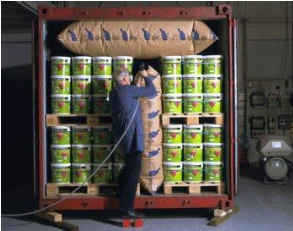
Рис. 11.3. Сучасна технологія кріплення пакетів вантажу на стандартних піддонах у великотоннажному контейнері (вагоні) за допомогою пневматичних подушок
