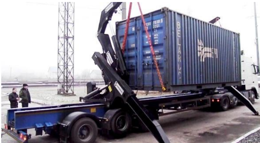
Рис. 3.25. Розвантаження великотоннажного контейнера в одержувача вантажу автомобільним саморозвантажувачем
