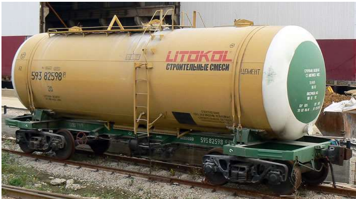
Рис. 20.17. Чотиривісна цистерна, модель 15-1405 і 15-1405-02 для цементу (вантажопідйомність 61 т, маса тари 24,3/26,5 т, об'єм котла 62/62,4 м 3 , допустима температура продукту, що завантажується -5 – +50 °С, внутрішній діаметр котла 2800 мм)
