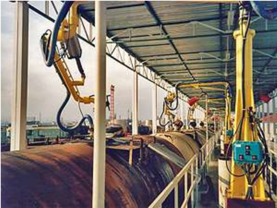
Рис. 5.5. Система верхнього наливу світлих нафтопродуктів у залізничні цистерни
