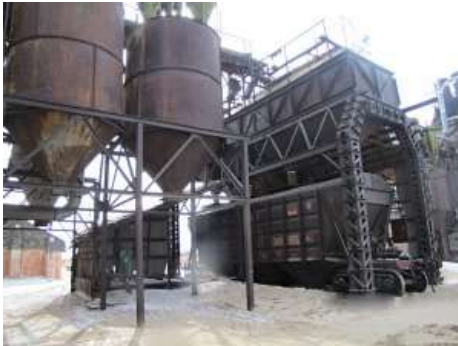
Рис. 14.3. Навантаження зерна у вагони стаціонарною установкою
