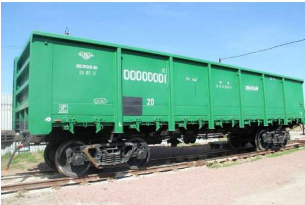
Рис. 19.7. Напіввагон моделі 12-9911, вантажопідйомність 70 т, об'єм кузова 78\text{ м}^3 для перевезення руднометалургійної сировини
