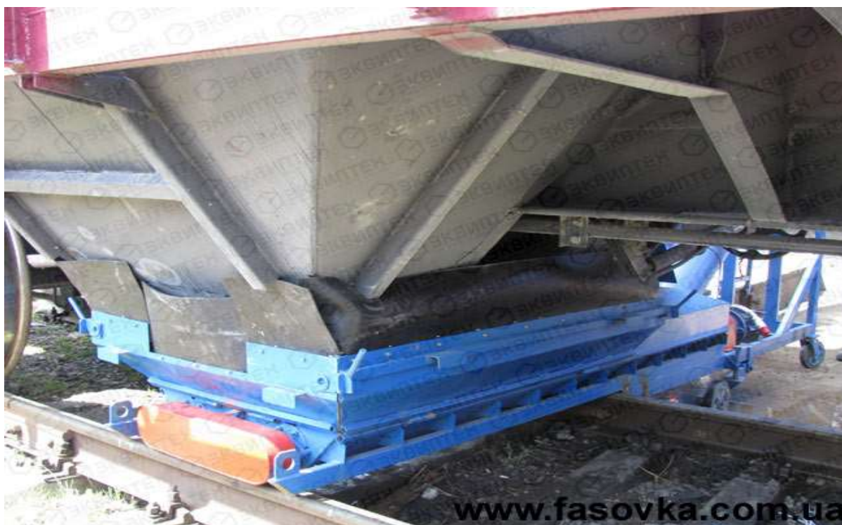
Рис. 20.16. Розвантаження хопер-цементовоза на залізничній колії шнековим пристроєм ВРХ-30Ц (продуктивність до 45 т, висота розвантаження – 1200 мм, час розвантаження – 2 год, потужність – 12 кВт)
