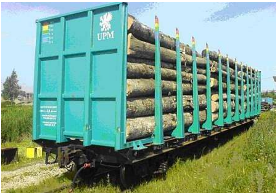
Рис. 22.9. Навантаження круглого лісу на спеціалізовану платформу моделі 13-3121: довжина платформи по осях автозчеплень 14,62 м, вантажопідйомність 70 т, навантажувальна довжина 13 м, тара 23,7 т, навантажувальна ширина по верху стійок 2,95 м, навантажувальна ширина по низу стійок 2,57 м
