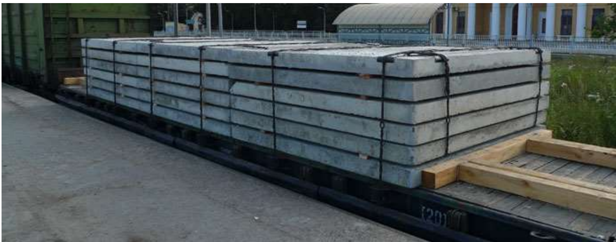
Рис. 20.23. Навантаження і кріплення залізобетонних плит обв'язками і упорними брусками на платформі
