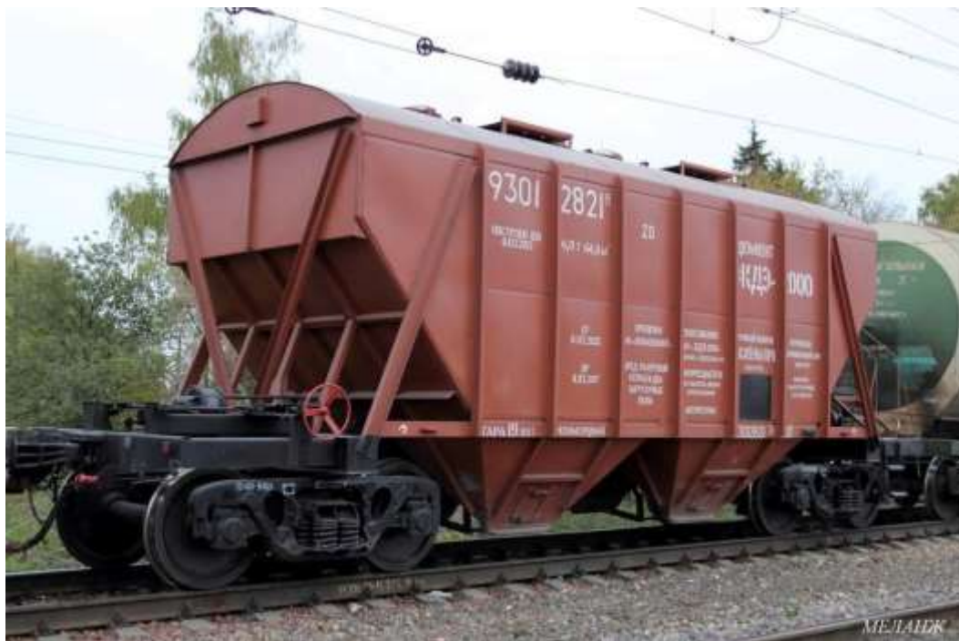
Рис. 20.11. Вагон-хопер цементовоз моделі 19-9838-01: вантажопідйомність 74 т, маса тари 19,5 т, об'єм кузова 64,0 м куб, кількість люків на завантаження -4, на розвантаження -4
