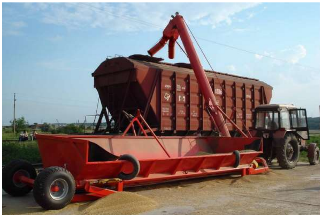
Рис. 14.4. Навантаження зерна у вагони пересувною установкою
