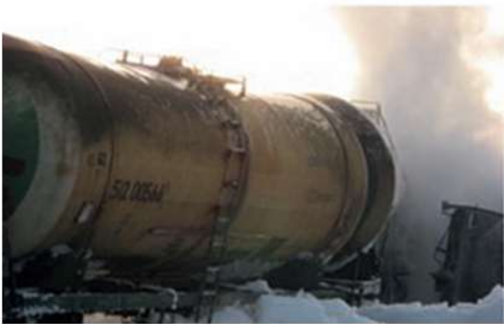
Рис. 8.4. Заходи з попередження виникнення пожежі (оходження) при аварійній ситуації з цистернами, завантаженими нафтопродуктами
