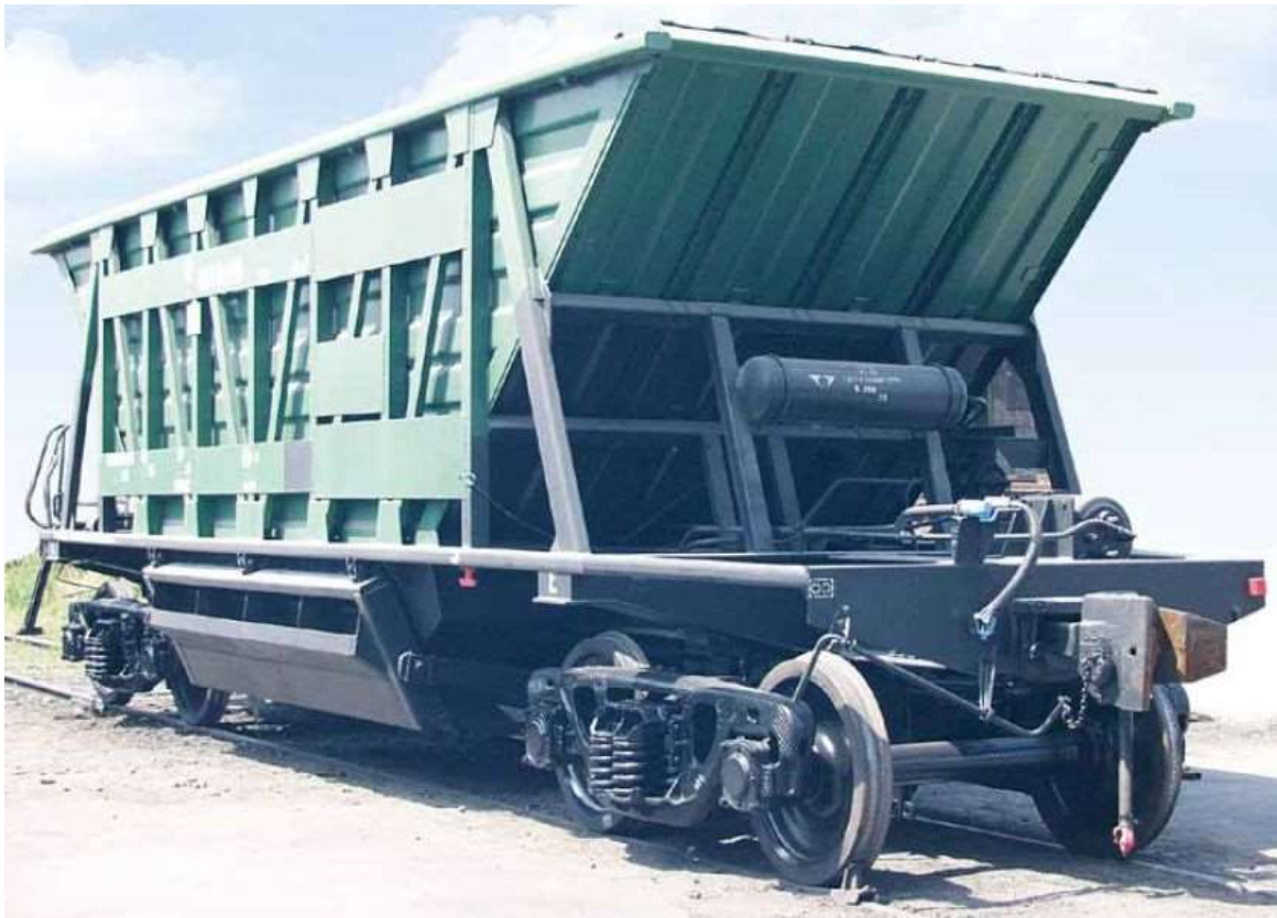
Рис. 19.6. Вагон-хопер моделі 20-4015 для перевезення гарячих окатишів і агломерату з температурою 700^{\circ}\text{C} з двома розвантажувальними люками, оснащеними розвантажувальним механізмом
