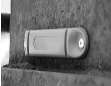
Рис. 3.7. Способи кріплення корпусної RFID-мітки на вагон: а – кріплення за допомогою заклепок; б – кріплення за допомогою кронштейна
