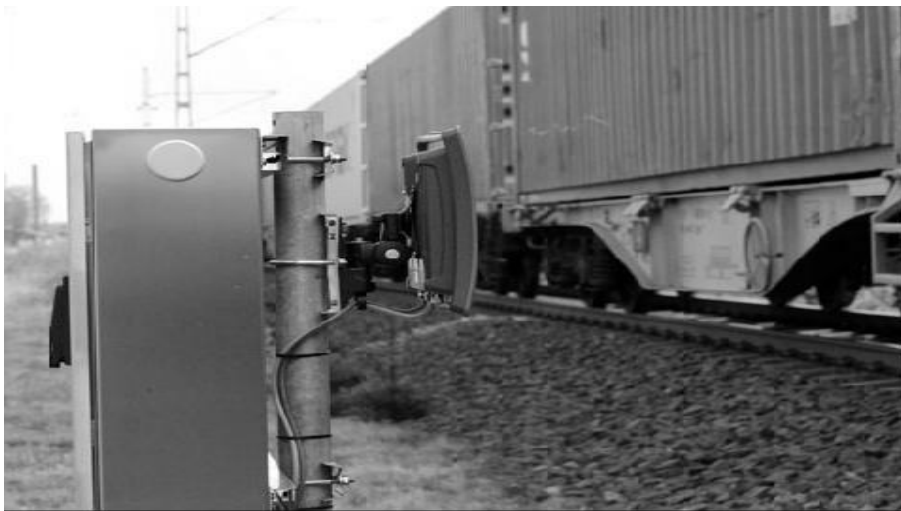
Рис. 3.8. Зовнішній вигляд RFID-зчитувача, призначеного для використання на залізничному транспорті
