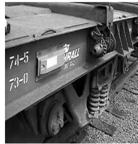
Рис. 3.7. Способи кріплення корпусної RFID-мітки на вагон: а – кріплення за допомогою заклепок; б – кріплення за допомогою кронштейна
