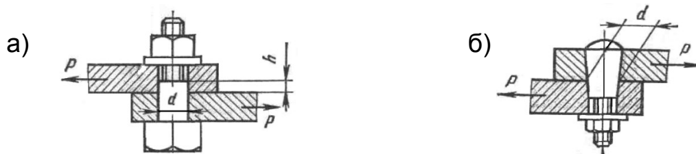
Рис. 1.20. Встановлення болтів в отвори деталей: а - болт циліндричний; б - болт конусний
