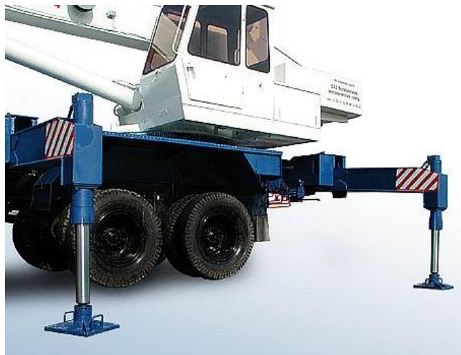
Рис. 7.5. Вигляд виносних опор-циліндрів і розташування механізму управління ними на неповоротній частині крана
