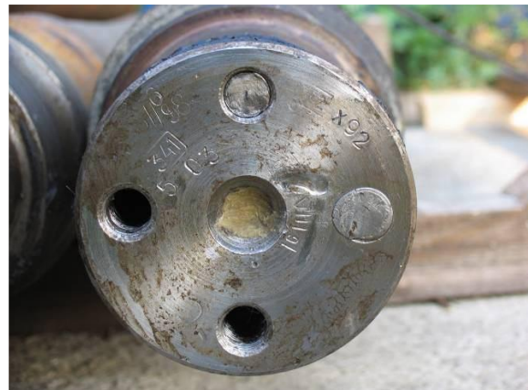
Рис. 4.40. Обрив головок болтів М20 торцевого кріплення підшипників на шийці осі РУ1Ш
