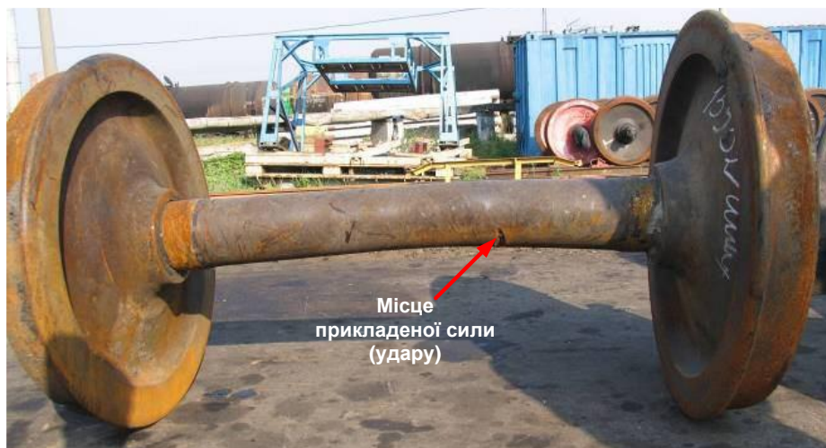
Рис. 4.43. Вигин осі колісної пари після сходу вагона
