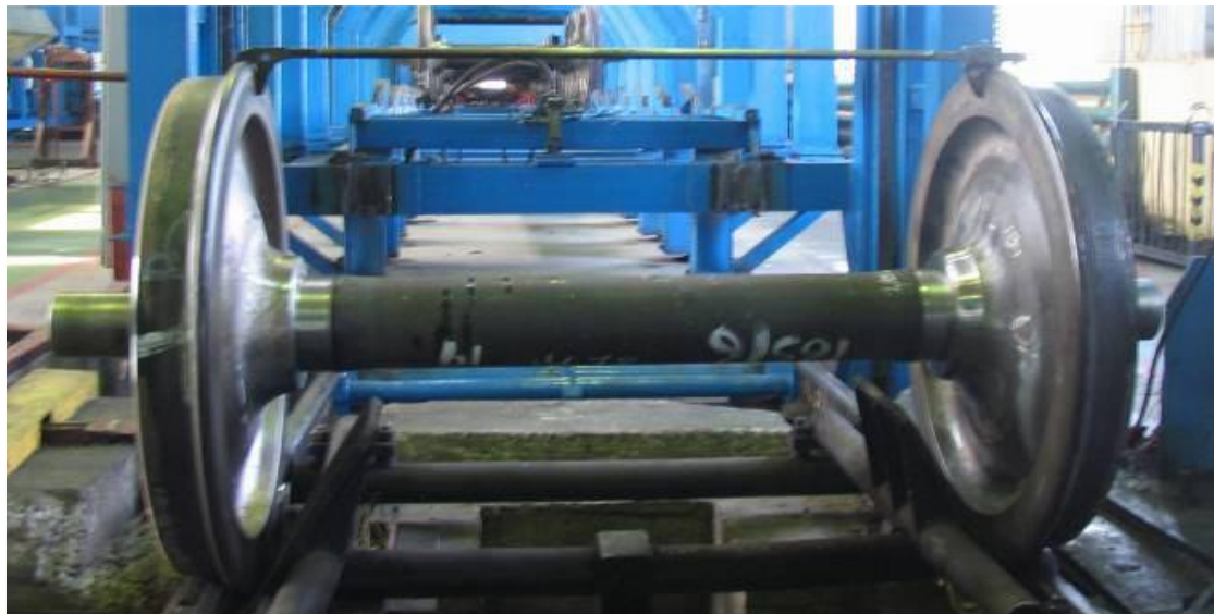
Рис. 4.83. Відстань між внутрішніми боковими поверхнями ободів коліс щодо відповідності допустимим розмірам (вимірювання штангенном "РВП")
