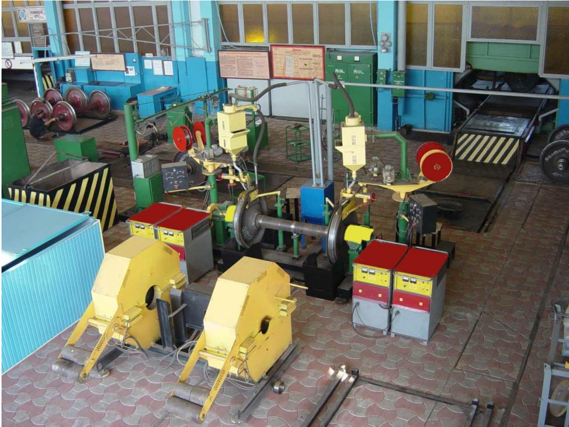
Рис. 9.4. Відділення двостороннього наплавлення гребенів коліс у горизонтальному положенні
