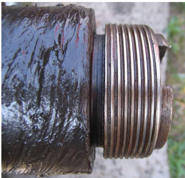
Рис. 4.36. Деформація (зріз) ниток різьби в результаті неякісного підбору гайки М110
