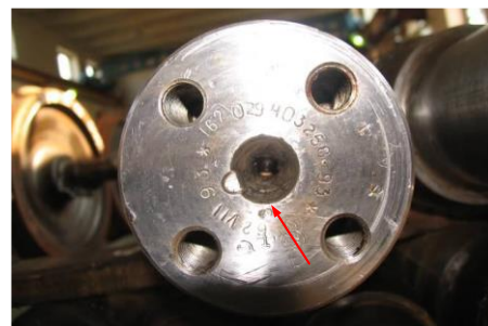
Рис. 4.30. Пошкодження центрального отвору осі типу РУ1Ш
