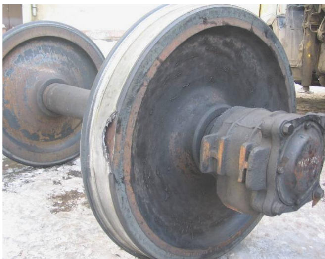
Рис. 4.67. Відколи зовнішньої бокової поверхні обода колеса
