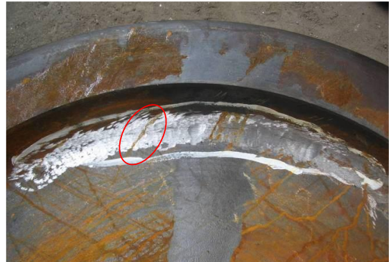
Рис. 4.55. Закочування металу в зоні диска біля обода
