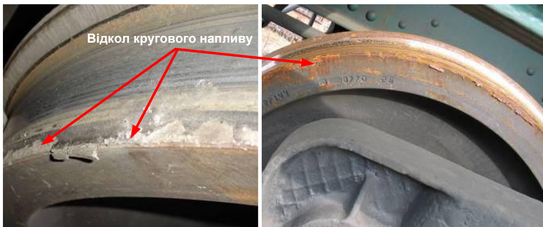
Рис. 4.68. Відкол кругового напливу зовнішньої бокової поверхні обода колеса
