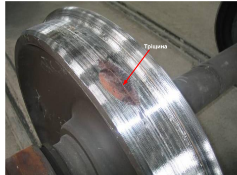
Рис. 4.51. Подовжня тріщина в ободі колеса через наявність неметалевого (після обточування колеса) включення
