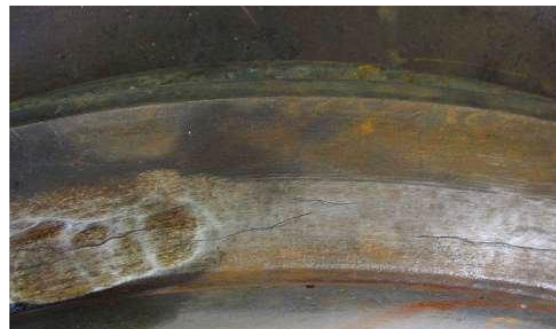
Рис. 4.53. Розшарування і плени на зовнішній боковій поверхні обода колеса
