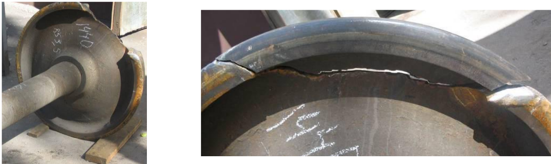
Рис. 4.72. Злам колеса по тріщині біля обода
