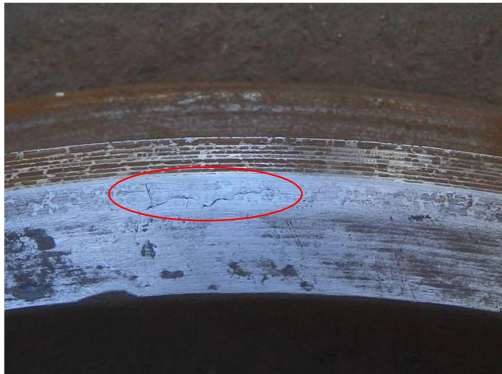
Рис. 4.54. Закочування на зовнішній поверхні обода колеса
