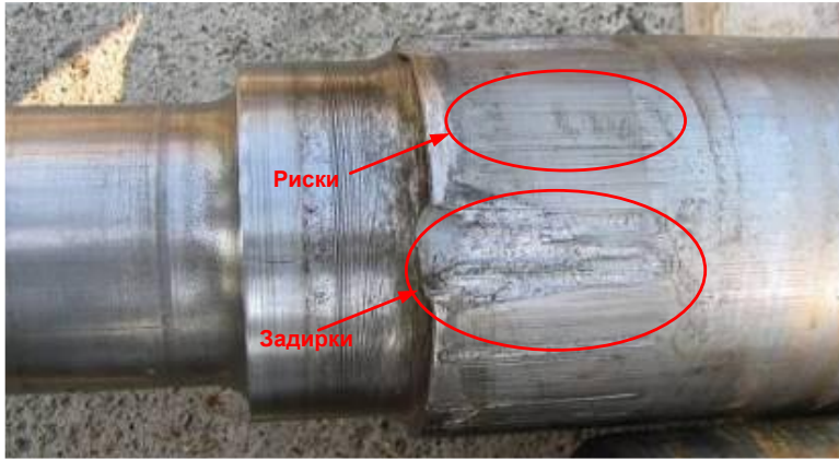
Рис. 4.10. Задирки і риски на підматочинних частинах осі
