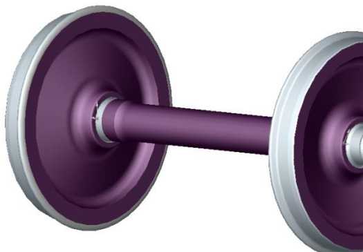
Рис. 5.56. Зсув маточини колеса на осі
