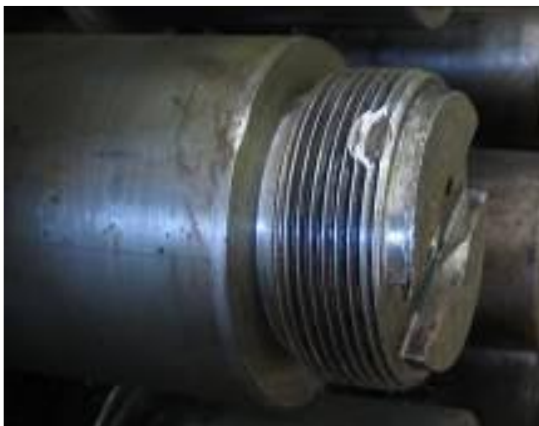
Рис. 4.32. Вирив ділянки різьби в результаті механічної дії
