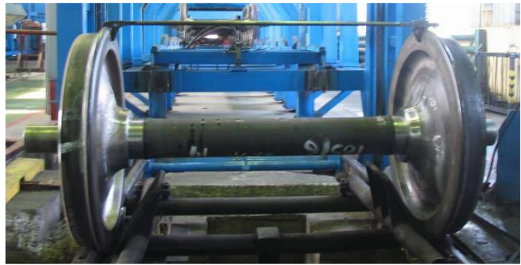
Рис. 4.87. Вимірювання різниці відстаней між внутрішніми боковими поверхнями ободів коліс штангеном "РВП"
