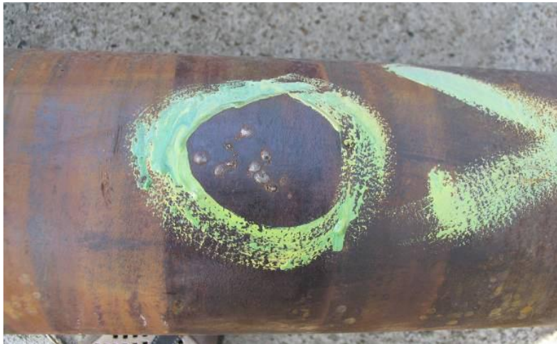
Рис. 4.20. Зварювальні опіки осі
