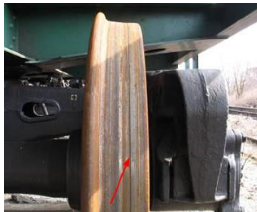
Рис. 4.7. Кільцеві виробки на поверхні кочення колеса вантажного вагона від взаємодії колеса з гальмівним башмаком
