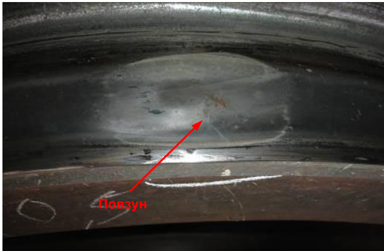
Рис. 4.19. Повзун на поверхні колеса
