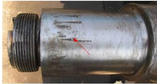
Рис. 4.12. Задирки на шийці осі в подовжньому напрямку
