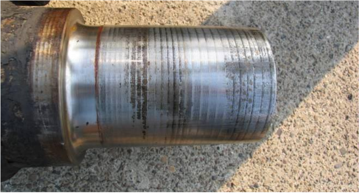
Рис. 4.16. Корозійні пошкодження шийки осі
