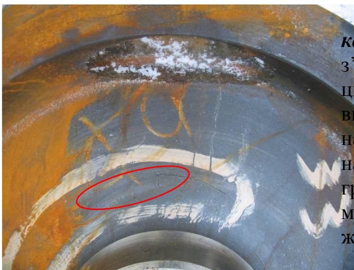
Рис. 4.59. Тріщина в диску біля маточини колеса
