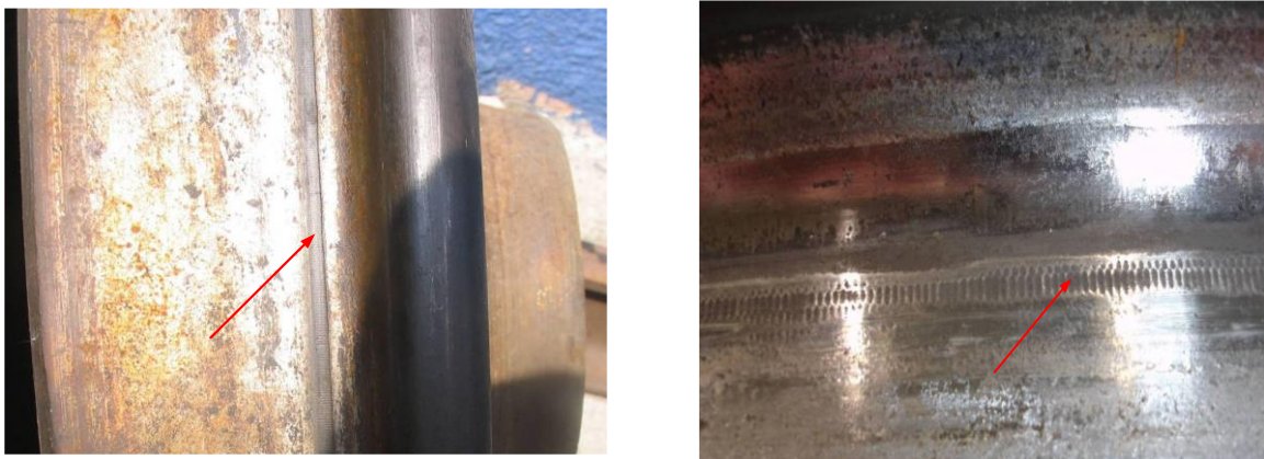
Рис. 4.9. Ураження поверхні кочення колеса електричним струмом (рифлення)
