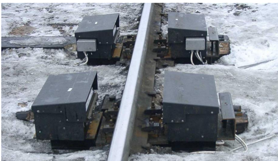
Рис. 6.6. Автоматизований безконтактний комплекс контролю колісних пар АБК. Вимірювальні модулі
