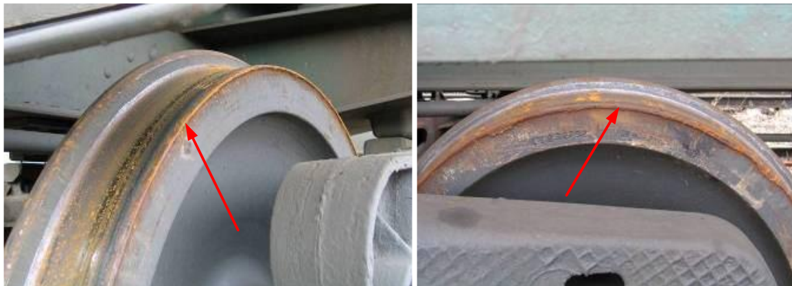
Рис. 4.22. Круговий наплив на фаску колеса
