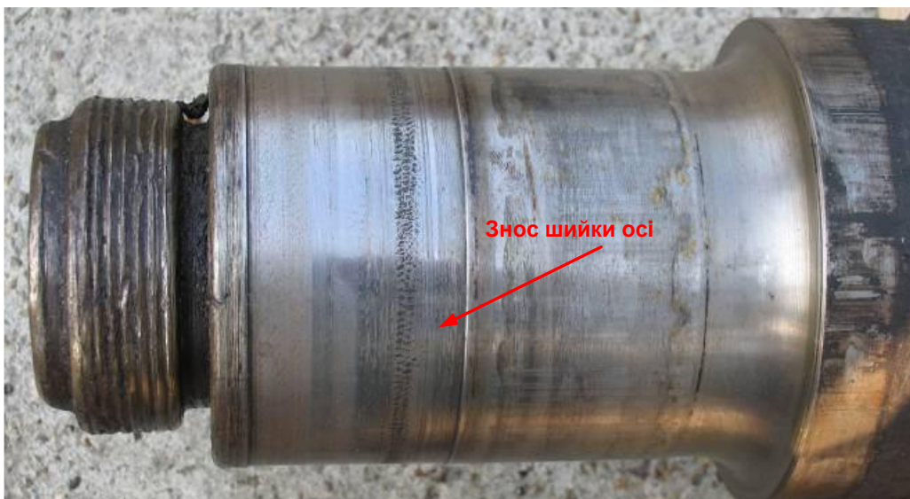
Рис. 4.17. Знос шийки осі через прокручування внутрішнього кільця
