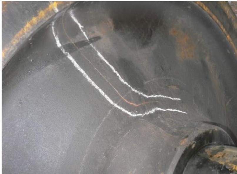
Рис. 4.60. Радіальна тріщина колеса
