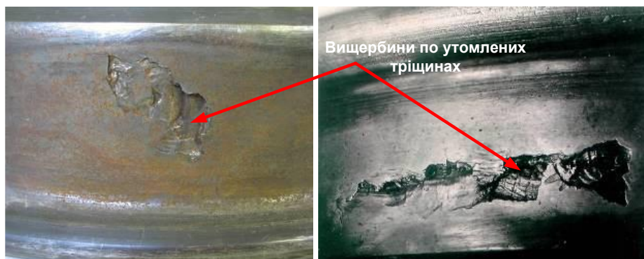
Рис. 4.65. Вищербини по втомних тріщинах
