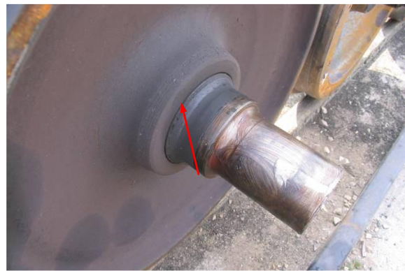
Рис. 4.42. Зсув колеса на осі (вигляд із зовнішнього боку колеса)
