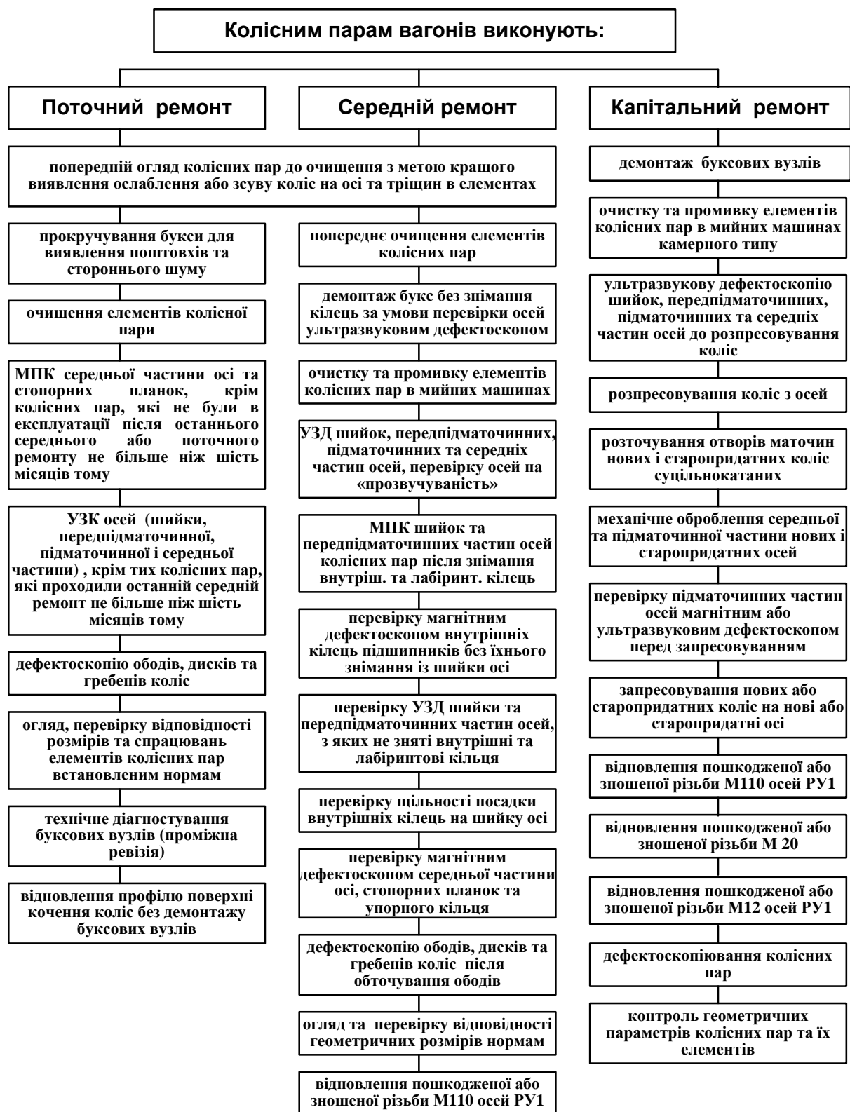
Рис. 8.1. Технологічна схема видів ремонту колісних пар
