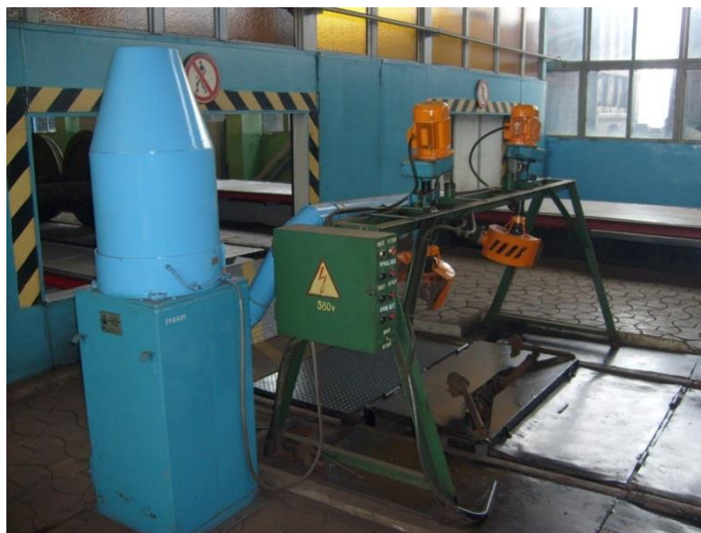
Рис. 7.5. Пристрій для механізованого очищення приобідної зони коліс
