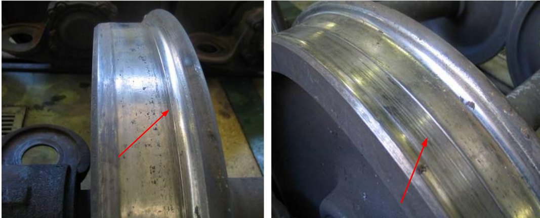
Рис. 4.8. Кільцеві виробки на поверхні кочення колеса пасажирського вагона від взаємодії колеса з чавунними гальмівними колодками
