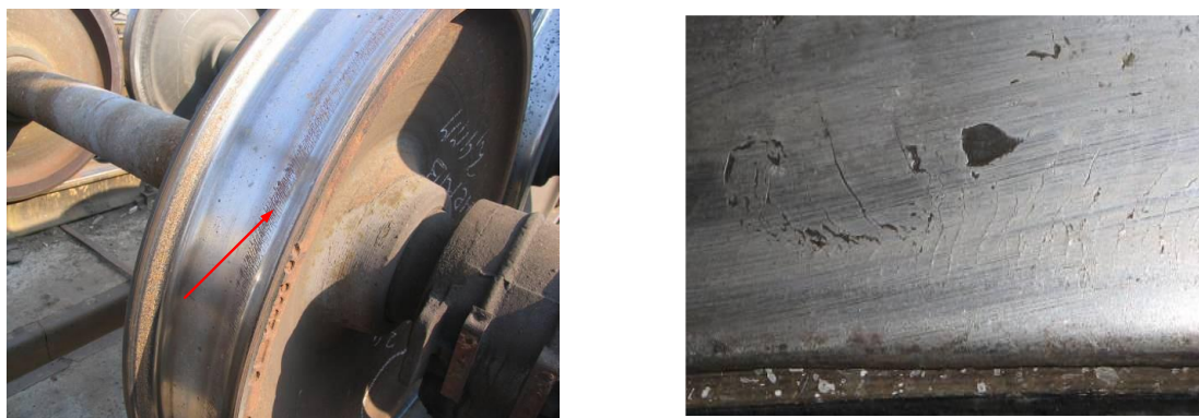
Рис. 4.45. Термічні тріщини на поверхні кочення обода
