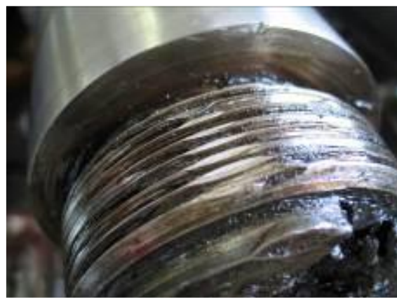
Рис. 4.33. Змінання різьби в результаті механічної дії лабіринтовою частиною корпусу букси при демонтажі з шийки осі
