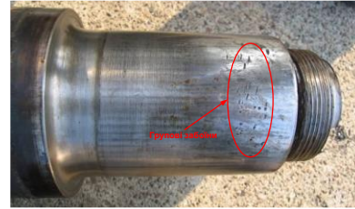
Рис. 4.28. Забоїна на середній частині осі
