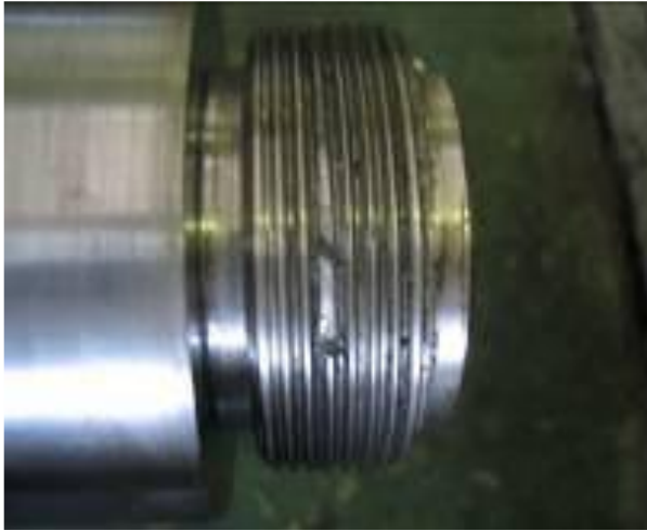
Рис. 4.34. Пошкодження (вирив) різьбової нитки по внутрішньому дефекту осі
