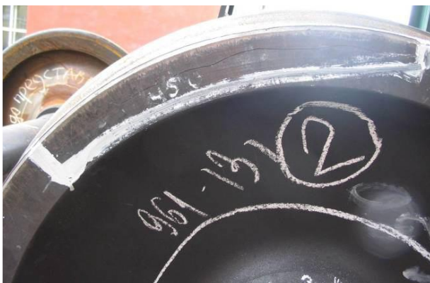
Рис. 4.52. Подовжня тріщина обода колеса
