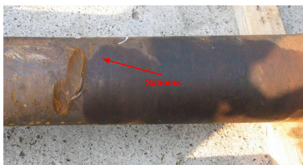
Рис. 4.26. Забоїна на середній частині осі
