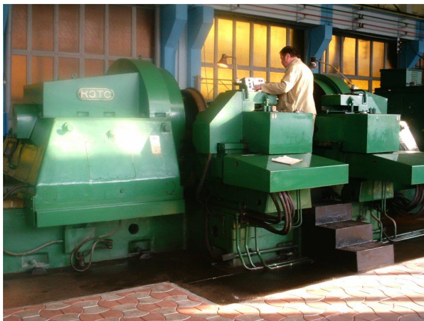
Рис. 9.1. Відновлення геометрії кочення й гребеня колеса на колесотокарному верстаті
