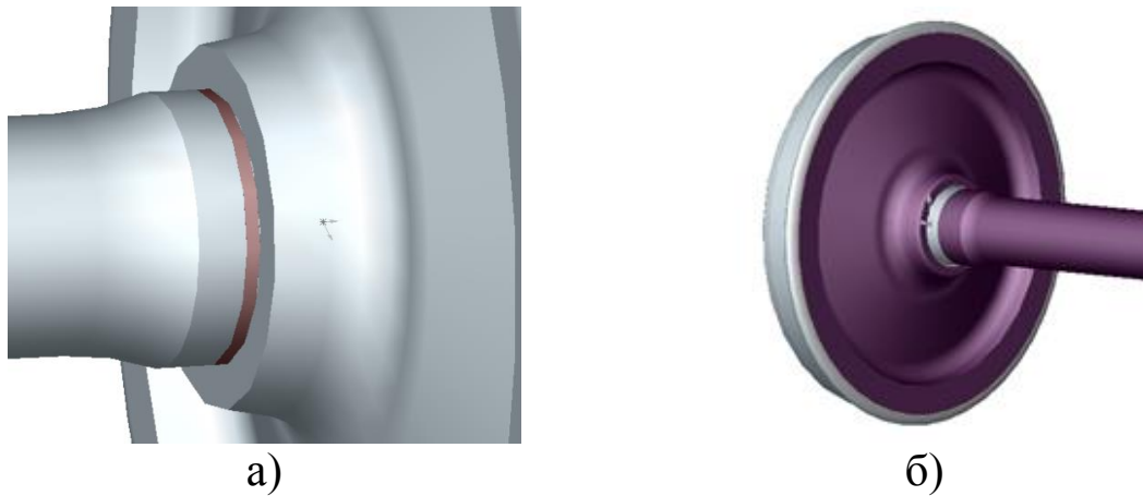
Рис. 6.2. Зміщення (а) і ослаблення маточини колеса (б) на підматочинній частині осі
