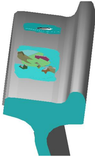
Рис. 5.12. Вищербини по світлих плямах, повзунах, наварях
