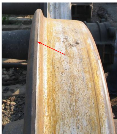
Рис. 4.21. Гострокінцевий накат гребеня
