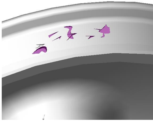
Рис. 5.13. Вищербини по тріщинах від втоми
