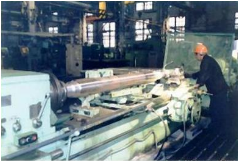
Рис. 2.3. Обточування осі на верстаті
