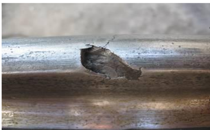
Рис. 4.69. Відкол гребеня колеса
