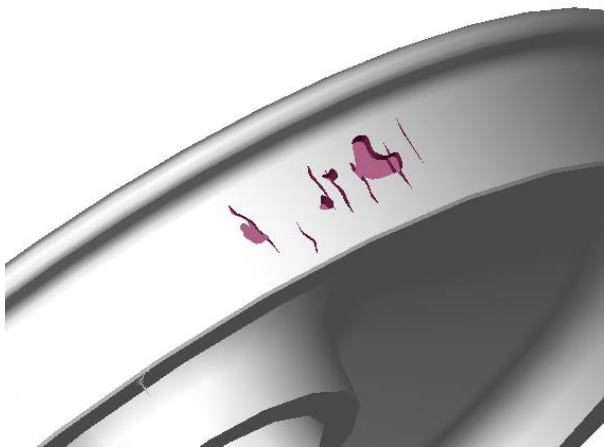
Рис. 5.14. Вигляд вищербини по сітці термотріщин
