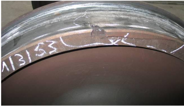
Рис. 4.50. Подовжня тріщина в ободі колеса через наявність неметалевого (до обточування колеса) включення
