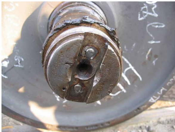
Рис. 4.39. Обрив головок болтів М12 кріплення стопорної планки в осі типу РУ1
