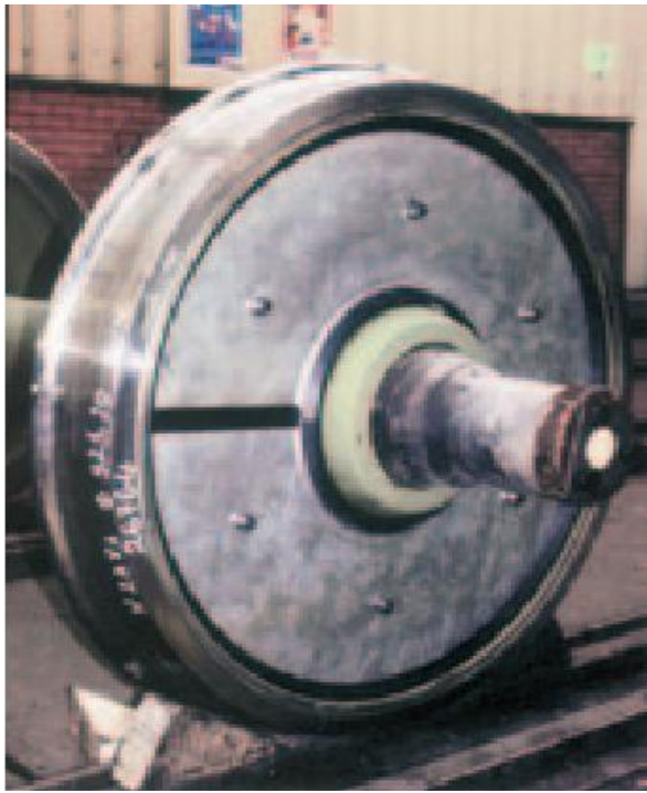
Рис. 1.50. Колісна пара з шумопоглинаючими дисками
