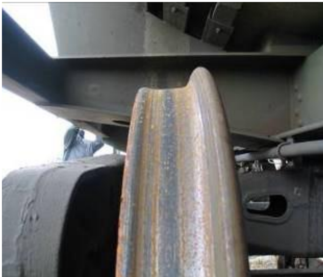
Рис. 4.1. Рівномірний прокат колеса по колу кочення
