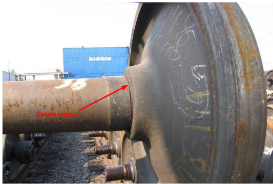
Рис. 4.41. Зсув колеса на осі (вигляд з внутрішнього боку колеса)
