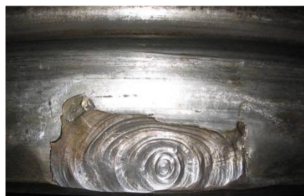
Рис. 4.67. Відколи зовнішньої бокової поверхні обода колеса
