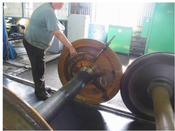
Рис. 4.89. Вимірювання діаметрів коліс скобою "ДК"
