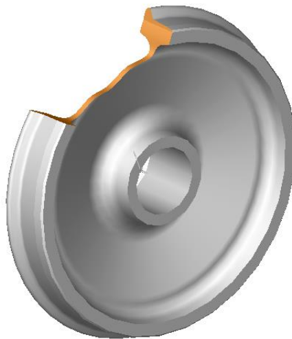
Рис. 5.25. Злам колеса по тріщині в ободі
