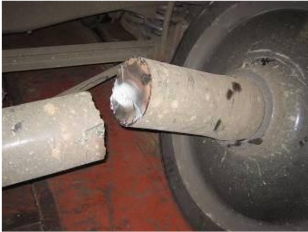
Рис. 4.77. Злам осі через розвиток тріщини в середній частині
