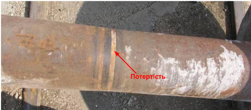
Рис. 4.14. Протертість на середній частині осі
