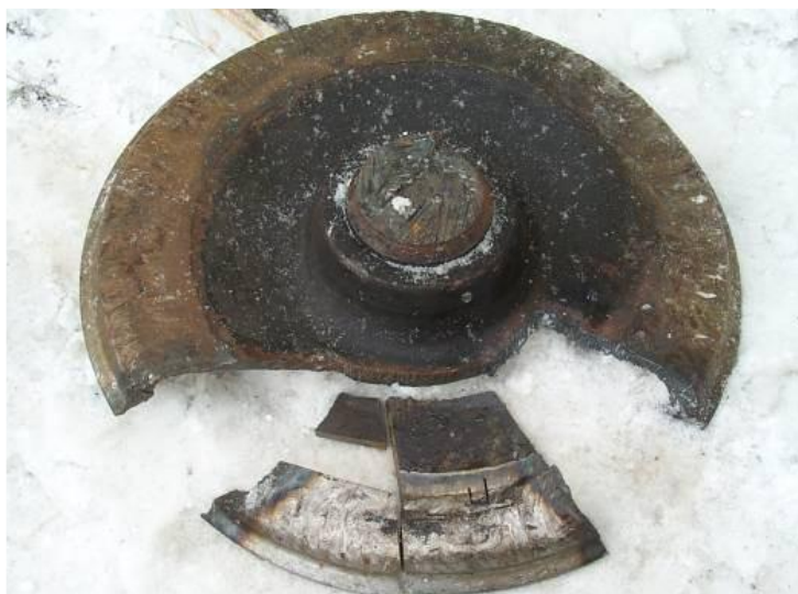
Рис. 4.71. Злам колеса по тріщині біля маточини
