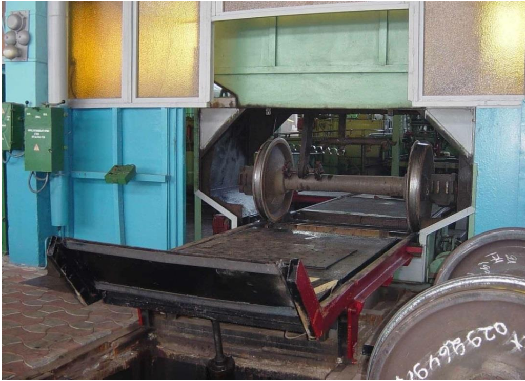
Рис. 7.6. Мийна машина для колісних пар
