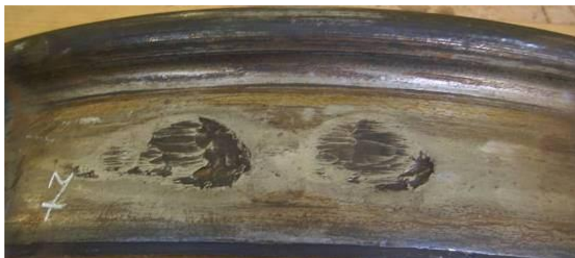
Рис. 4.64. Вищербини по світлих плямах, повзунах, наварах
