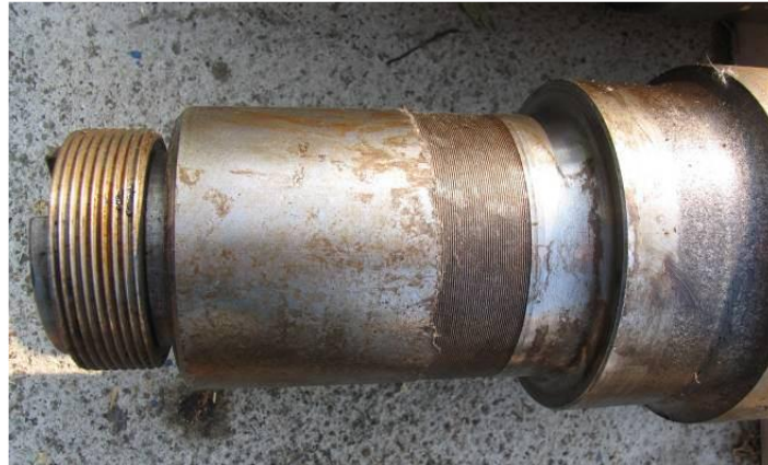
Рис. 4.70. Руйнування напиленого шару відновленої шийки осі
