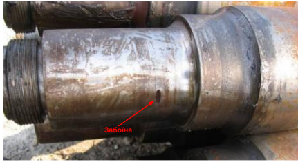
Рис. 4.27. Забоїна на шийці осі
