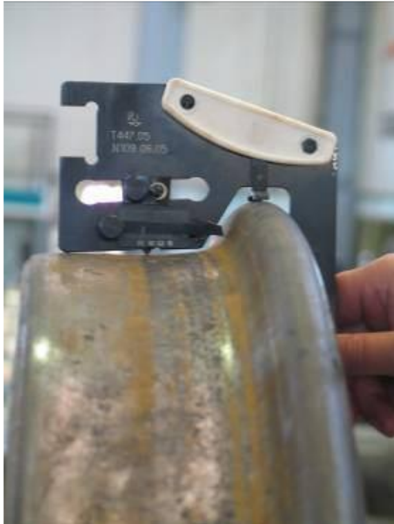
Рис. 4.4. Вимірювання зносу гребеня колеса абсолютним шаблоном
