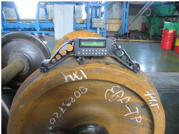
Рис. 4.88. Вимірювання діаметрів коліс приладом "МАИК"
