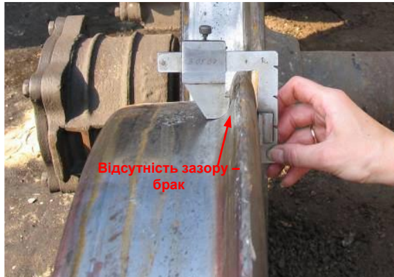
Рис. 4.5. Вимірювання вертикального підрізу гребеня колеса
