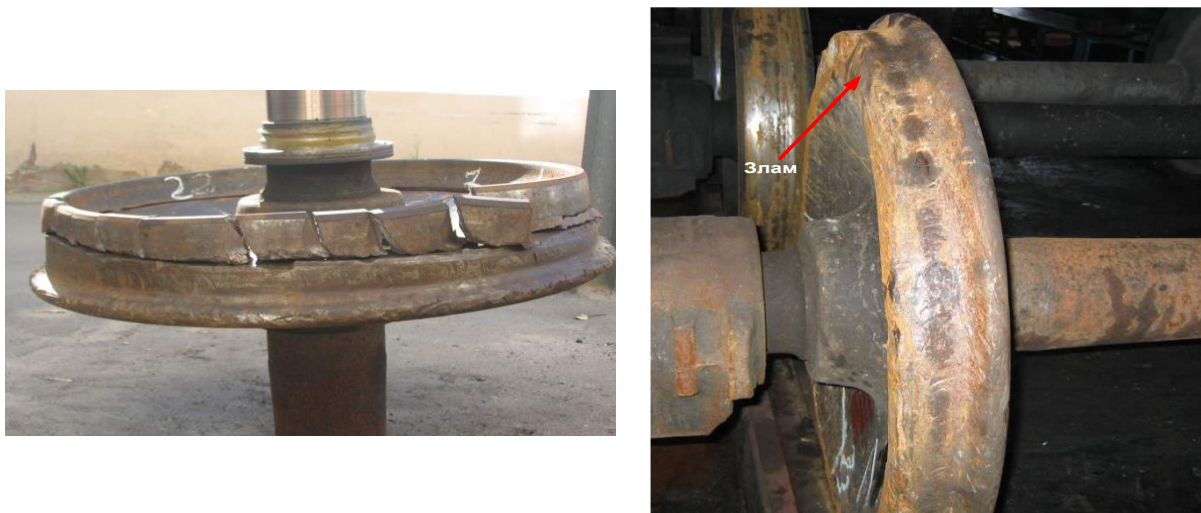
Рис. 4.73. Злам обода колеса в круговому напрямку
