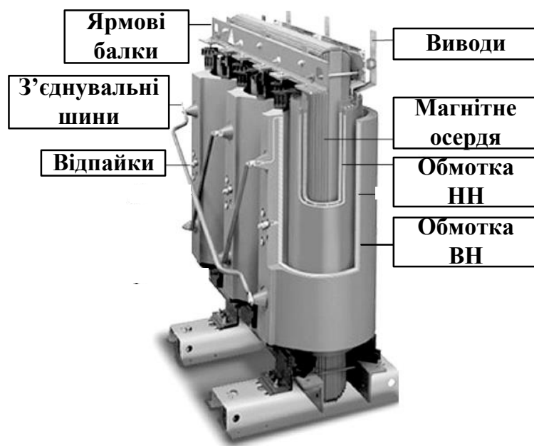
Рис. 13.2. Силовий сухий трансформатор
