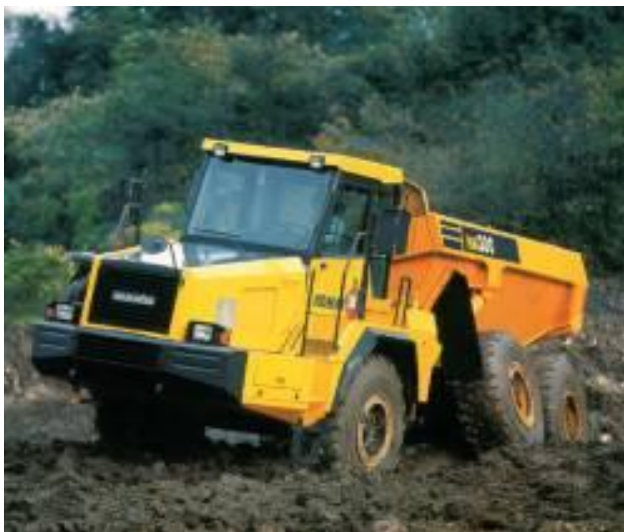
Рис. 2.14. Самоскид із шарнірно-зчленованою рамою фірми KOMATSU NM 3001
