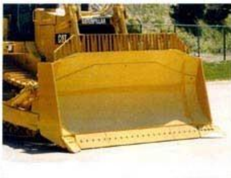
Рис. 3.74. Напівсферичний відвал з козирком фірми "Caterpillar"
