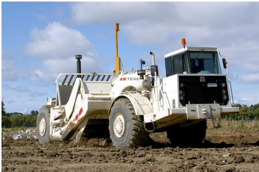
Рис. 3.15. Самохідний двомоторний скрепер TEREX TS14G
