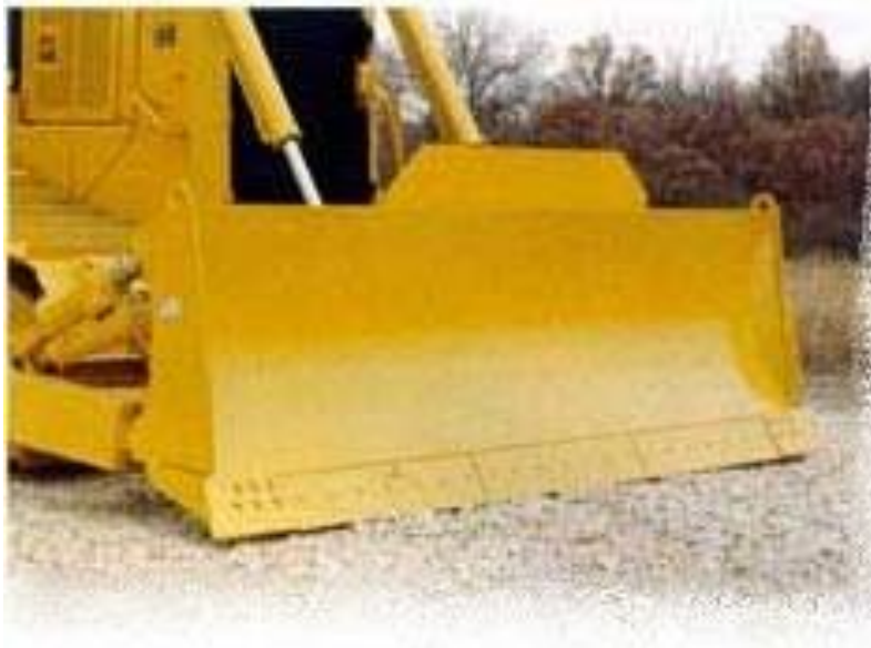
Рис. 3.72. Прямий неповоротний відвал бульдозера фірми "Caterpillar"
