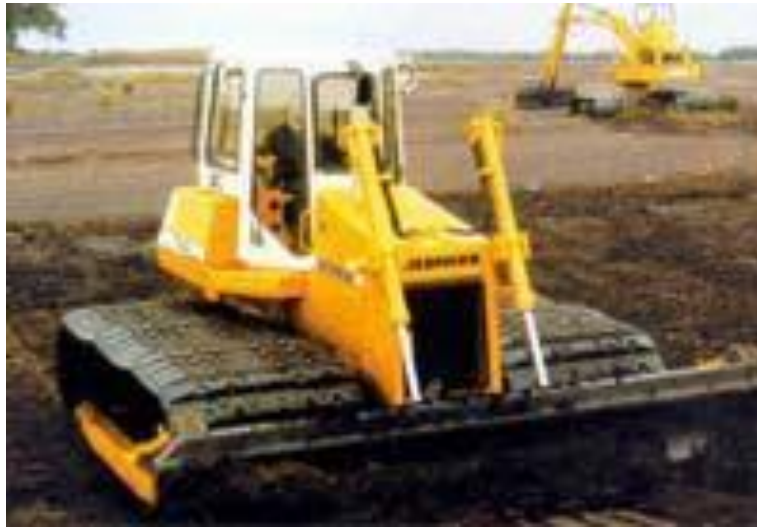
Рис. 3.77. Спеціальний відвал для переміщення вугілля, тріски і торфу
