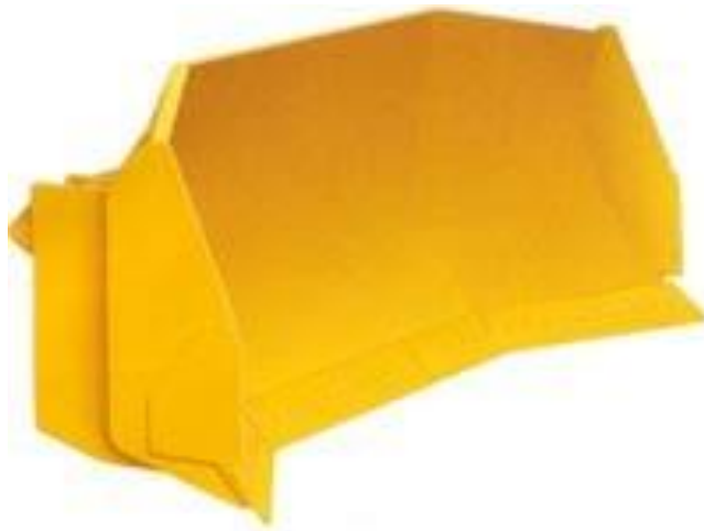
Рис. 3.73. Сферичний відвал бульдозера фірми "Caterpillar" центральної секції
