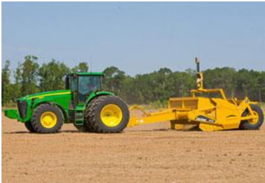
Рис. 3.2. Причіпний скрепер з нерухомим ножем від фірми «John Deere»
