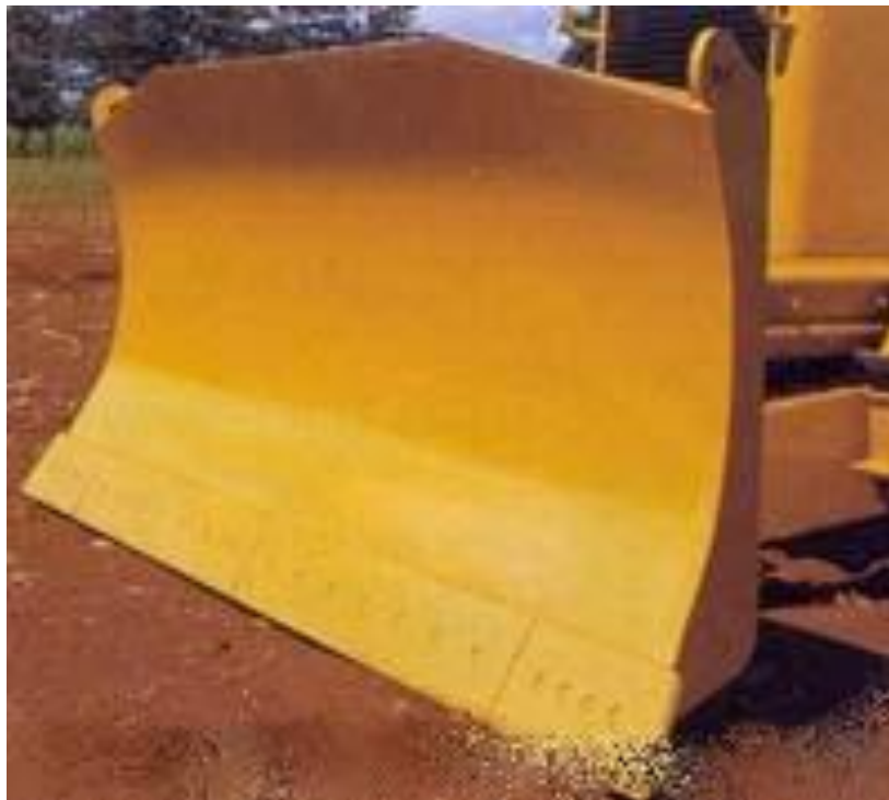
Рис. 3.75. Поворотний відвал бульдозера фірми "Caterpillar"
