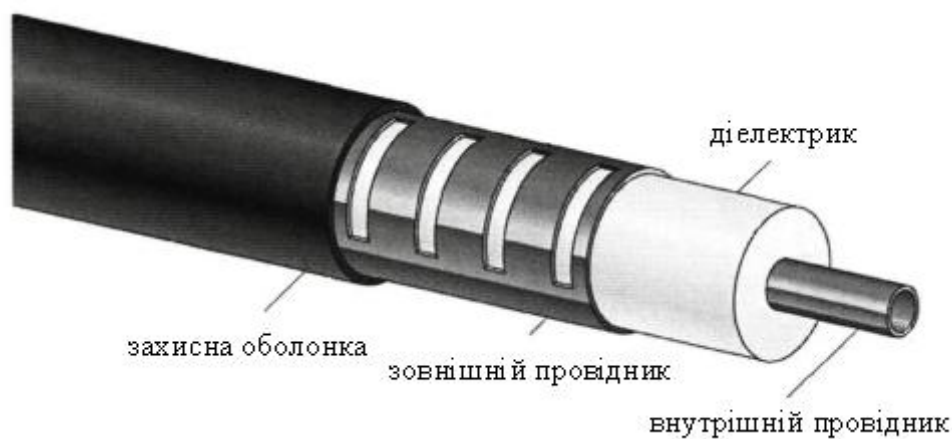
Рис. 4.9. Конструкція випромінюючого кабелю
