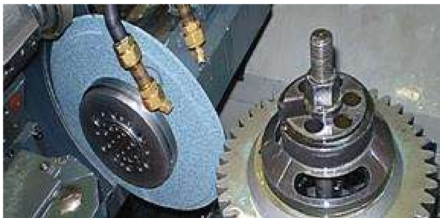
Рис. 1. Зона обробки зубчастого колеса на шліфувальному верстаті
