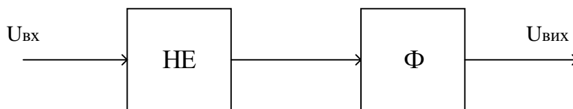
Рисунок 1.2 – Структурна схема амплітудного детектора
