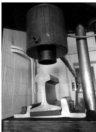
Рис. 7 Експериментальні випробування пружних властивостей дерев'яних шпал зі скріпленням типу "метро".
