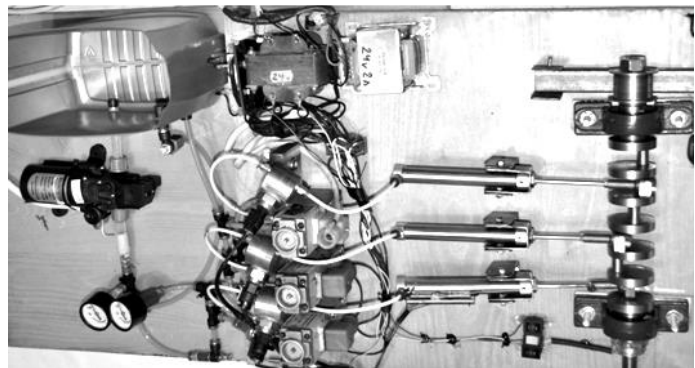
Рисунок 16 – Мотор на базі циліндрів з гідравлічним джерелом енергії: а – гідрокінематична схема; б – загальний вигляд
