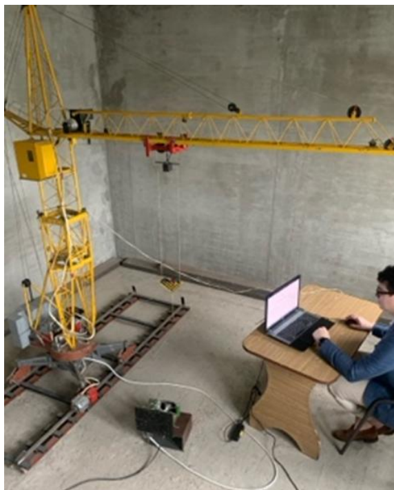
Рис. 8. Модель баштового крана КБ-403А (масштаб 1:20)
