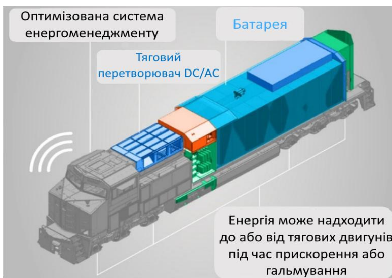
Рис. 6. Структура електричного акумуляторного локомотива (модифікований BNSF)
