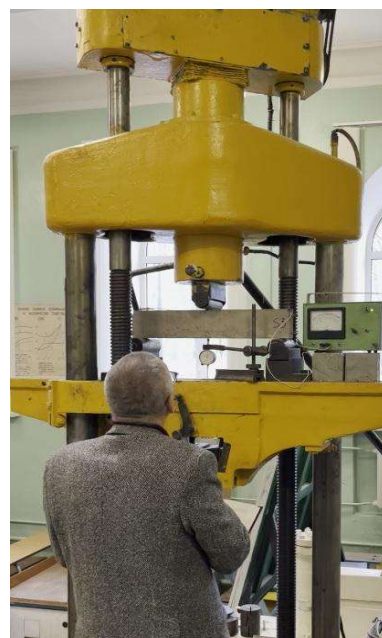
Рис. 2. Схема моделі ( a ) та її випробування на гідравлічному пресі ( б )
