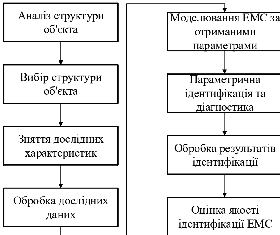
Рисунок 2 – Послідовність операцій під час ідентифікації й діагностики параметрів тягових асинхронних електричних двигунів
