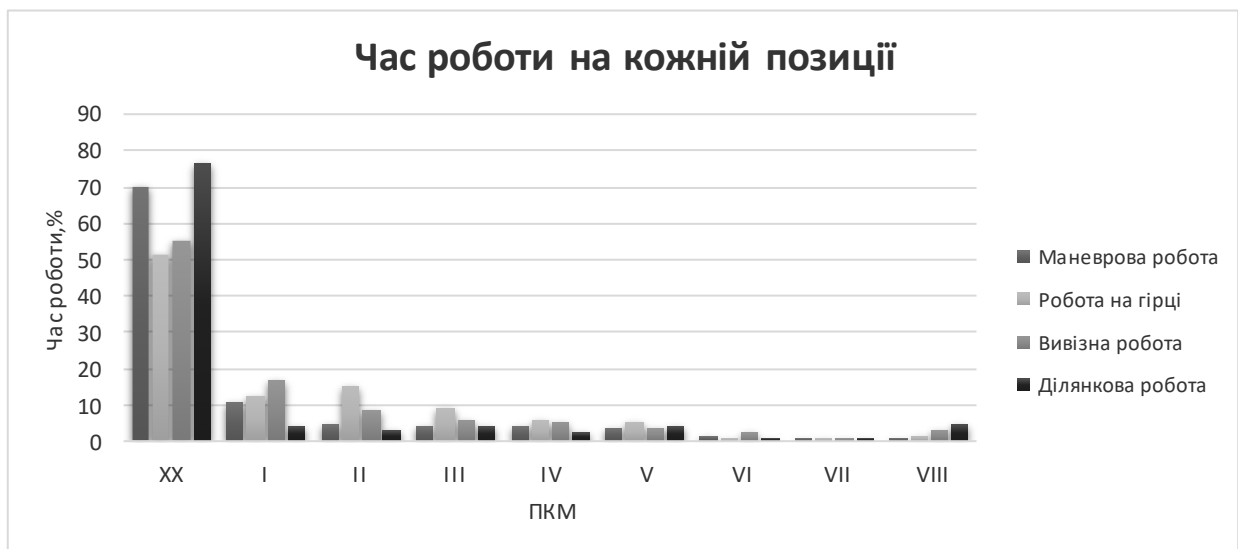
Рисунок 15 – Частка часу роботи маневрового тепловоза залежно від типу маневрових робіт
