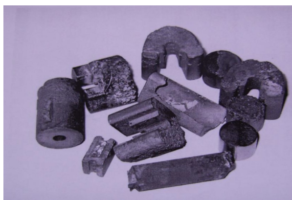
Рисунок 2 – Металеві відходи 2-ї групи: брак виливків, виявлений у цеху лиття (за хімічним складом, недоливами, тріщинами тощо)
