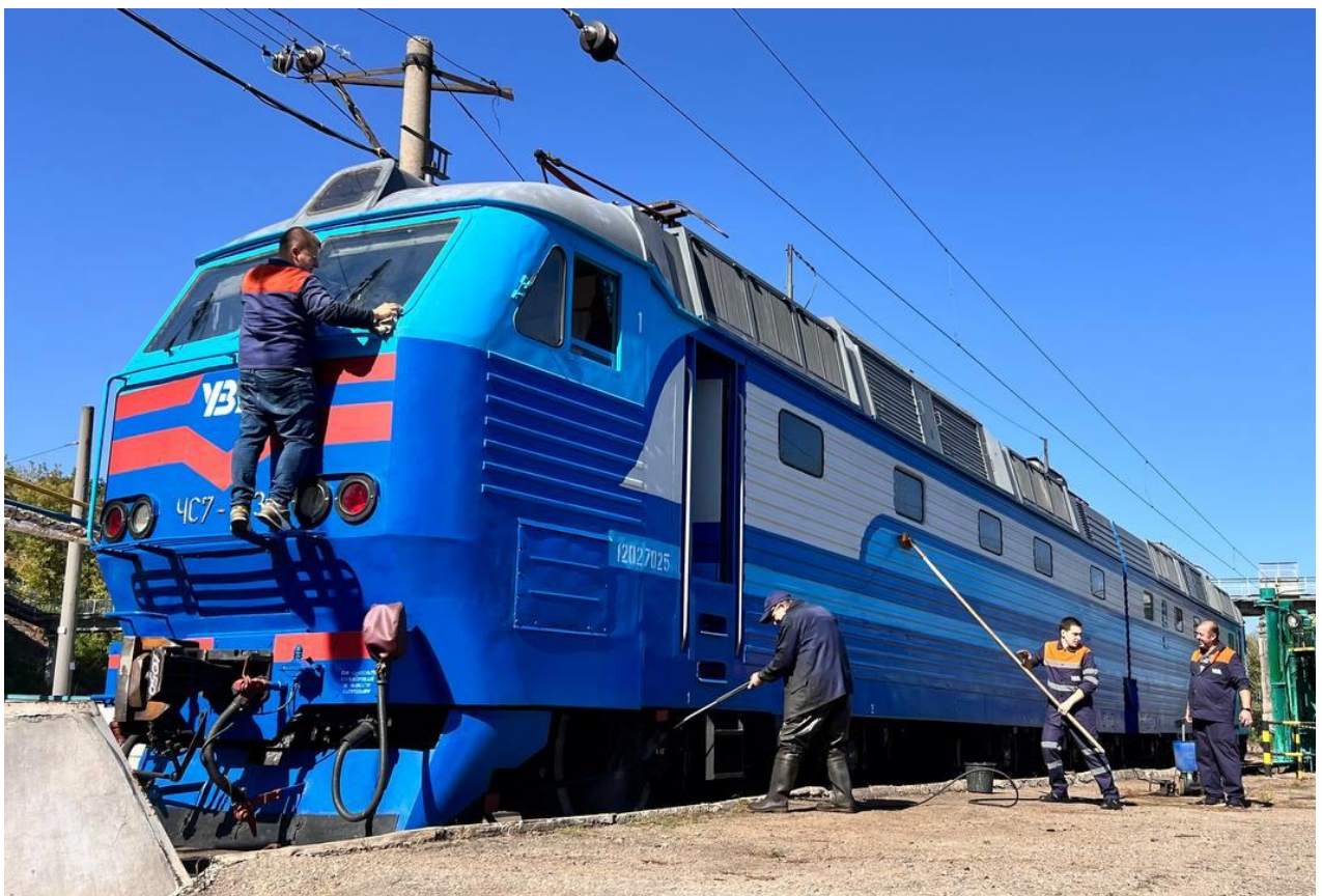
Рисунок 1.5 – Виконання осіннього комісійного огляду електровоза ЧС7 в Електровозному депо Харків-Головне
